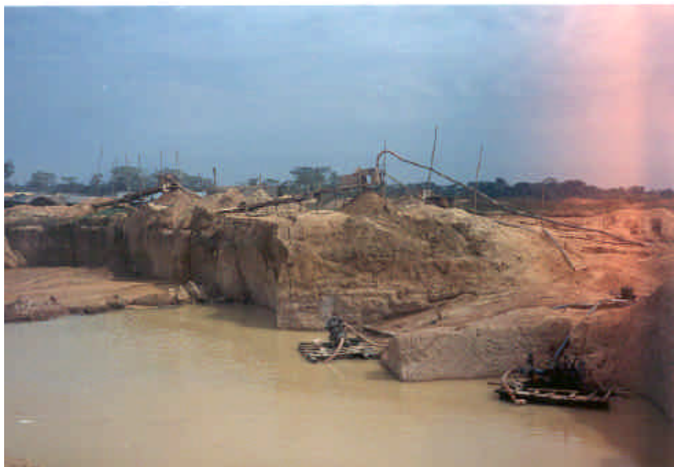
Foto 11 – Lavra com desmonte hidráulico e formação de lagoas no garimpo do Araras, antiga Vila Nova, atual Nova Mamoré (RO) (1990).
