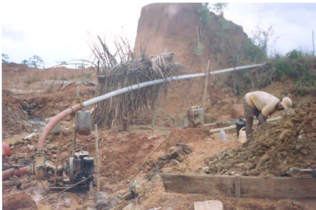
Foto 7 – Lavra por desmonte hidráulico, com detalhe da bomba e tubulação, próxima à vila do Araras, Nova Mamoré (RO).
