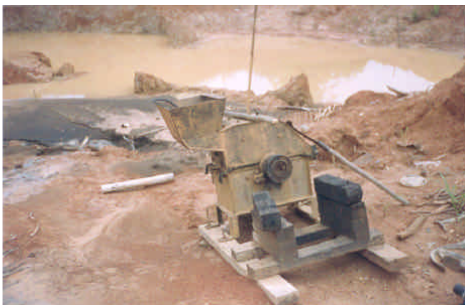
Foto 14 - Moinho de martelos para beneficiamento de material aurífero. Lavra atual próxima do Araras.
