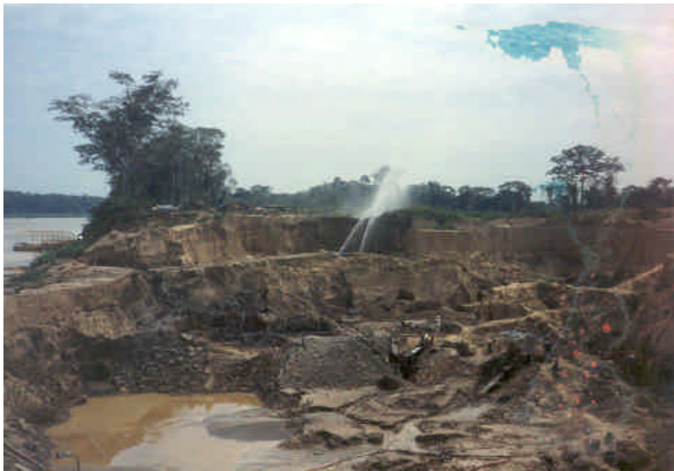
Foto 10 – Lavra com desmonte hidráulico no garimpo do Araras – Nova Mamoré (RO) (agosto 1990).
