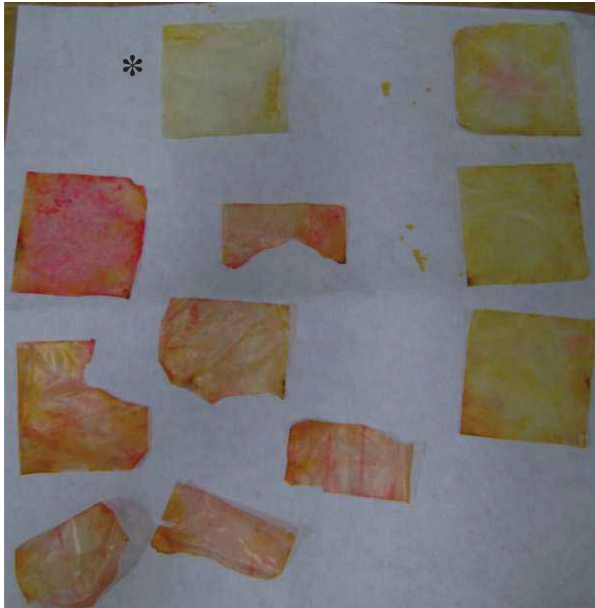
Figura Anexo 10. Revelação laboratorial por nebulização das membranas. A membrana com um asterisco representa o branco. As 3 membranas do lado direito da figura são coletas onde havia pouco resíduo para ser coletado.
