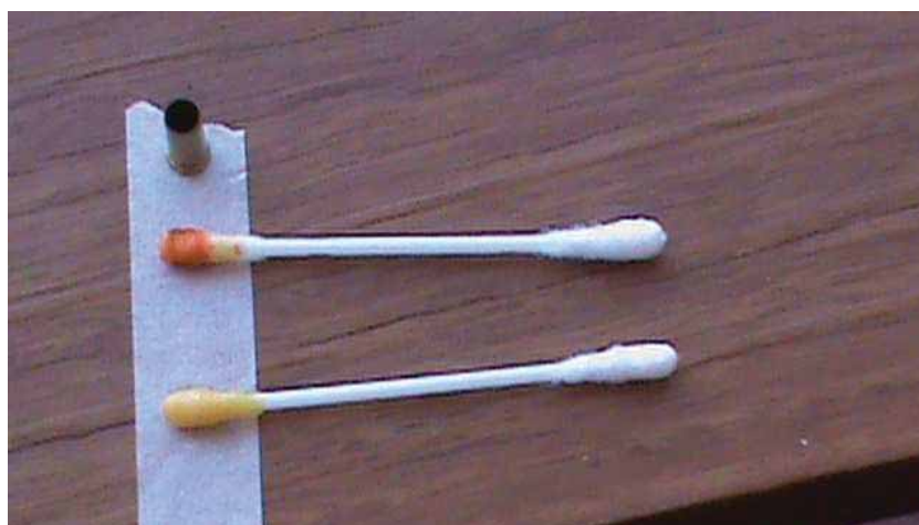
Figura Anexo 8. Resultado in situ de uma coleta qualitativa de resíduos em um cartucho calibre .22. A coloração amarela representa o branco enquanto a vermelha é o resultado da reação.
