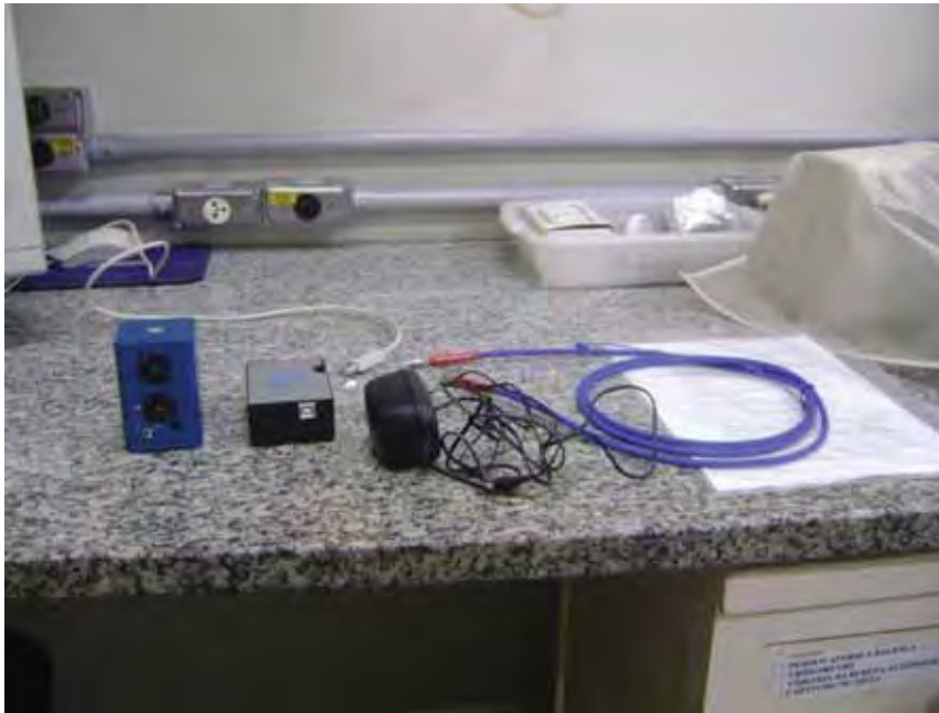
Figura 13. Espectrômetro portátil e fibra óptica utilizados.
