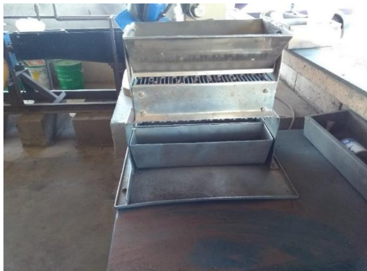
Figura 17: Quarteador Jones, utilizados para redução das amostras na COOPERSANTA.
