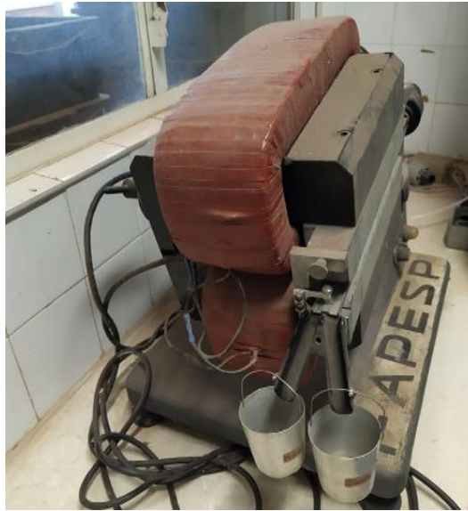
Figura 20: Separador Magnético tipo Frantz da marca Isodynamic, Modelo L.
