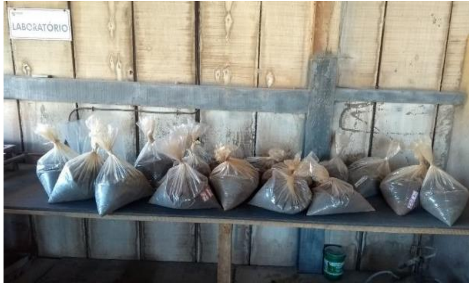
Figura 16: Amostras retiradas das pilhas de rejeito magnético, com cerca de 6 kg.
