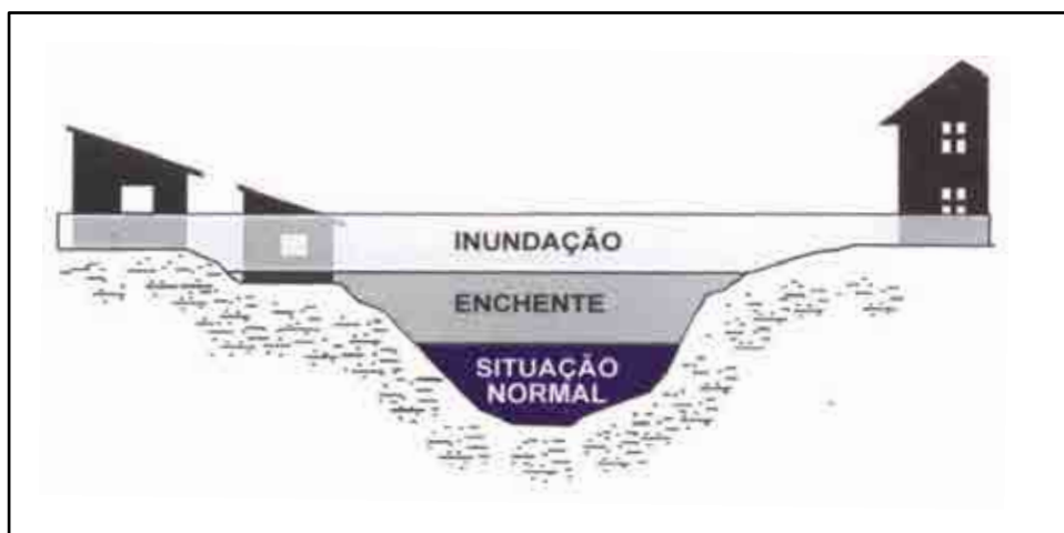
Figura 11: Perfil esquemático do processo de enchente e inundação (Ministério das Cidades/IPT, 2007, p.92).
