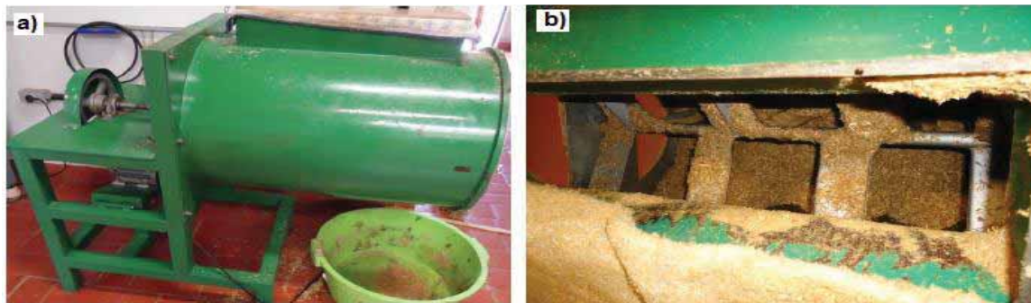
Figura 7 - Misturador horizontal de tambor (a) e partículas com adesivo dentro do misturador (b).
