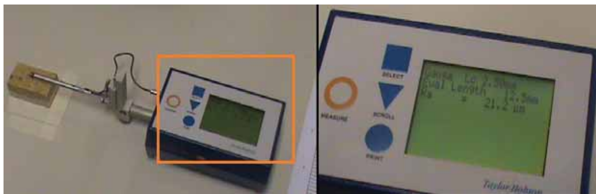
Figura 22 - Rugosímetro da marca TAYLOR HOBSON
