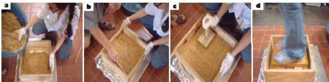
Figura 8 - Sequência da preparação do colchão de partículas para prensagem.
