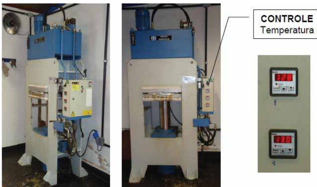
Figura 11 – Prensa hidráulica a quente, marca PHS e modelo PHH 80T.
