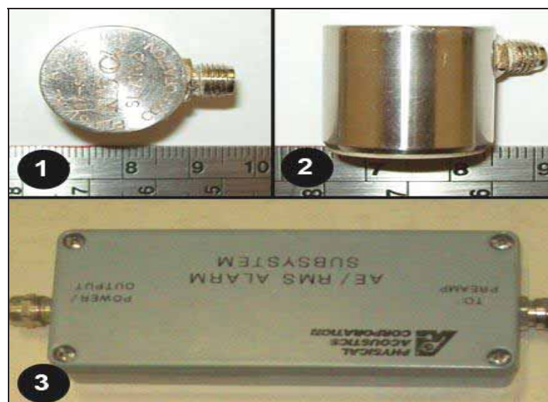
Figura 19 - Módulo de emissão acústica, sensor (1) (2) e amplificador (3)
