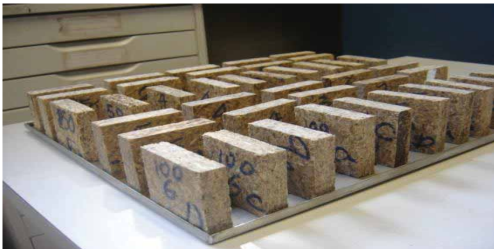
Figura 16 - Corpos de prova retirados da estufa.
