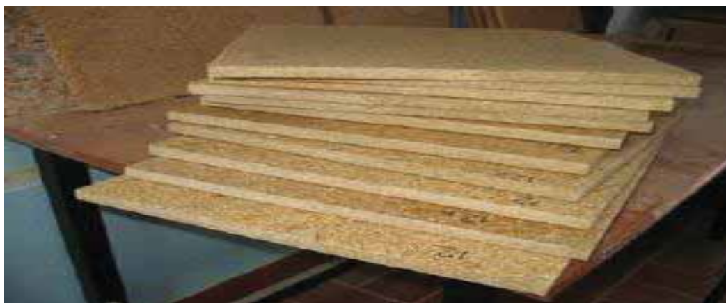
Figura 12 - Vista das chapas após o processo de esquadrejamento.
