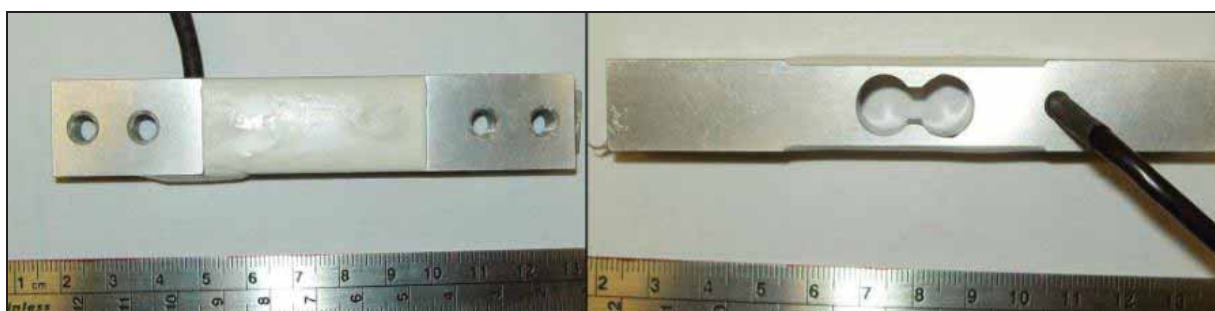
Figura 18 - Célula de carga modelo TBSPL
