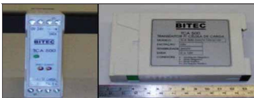
Figura 21 - Amplificador da célula de carga TCA500
