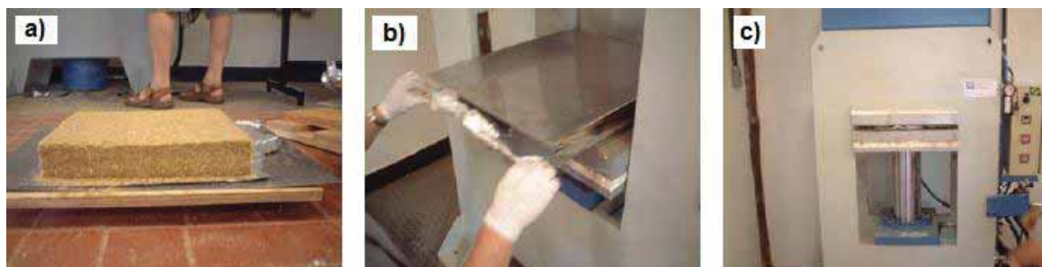
Figura 10 - Sequência para prensagem da chapa de partículas.
