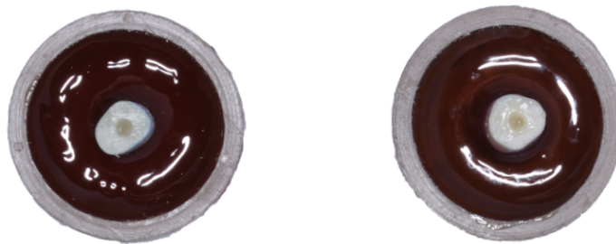
Figura 13 - Raízes inseridas no anel de PVC com resina de poliestireno
