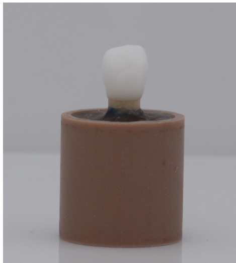
Figura 23 - Corpo-de-prova após cimentação da coroa de zircônia Y-TZP
