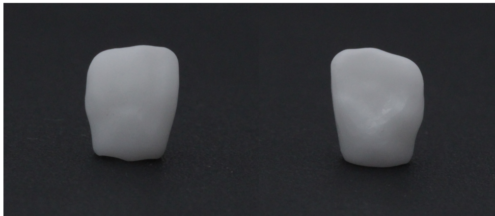
Figura 22 - Aspecto final da coroa em Y-TZP após fresagem
