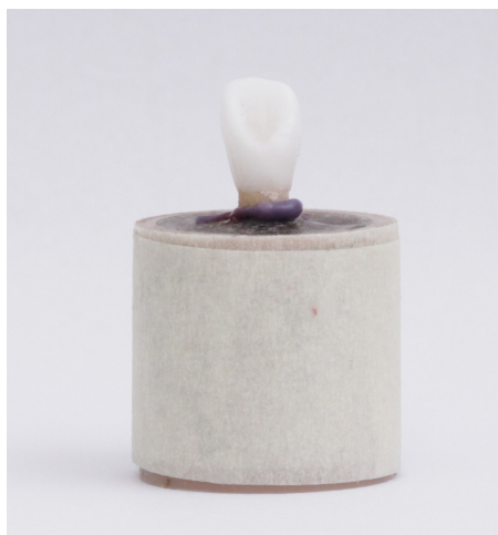
Figura 16 - Simulação do ligamento periodontal com Impregum Soft
