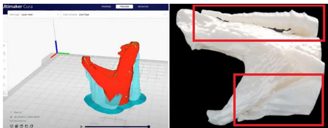
FIGURA 31. Criação de um suporte em modo “Árvore”.
