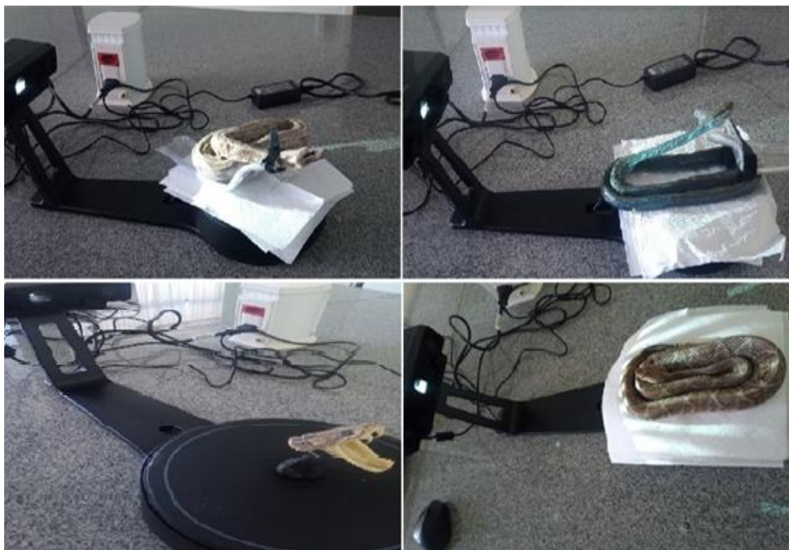
FIGURA 15. Escaneamento 3D das cabeças das serpentes e das escamas quilhada e lisa.
