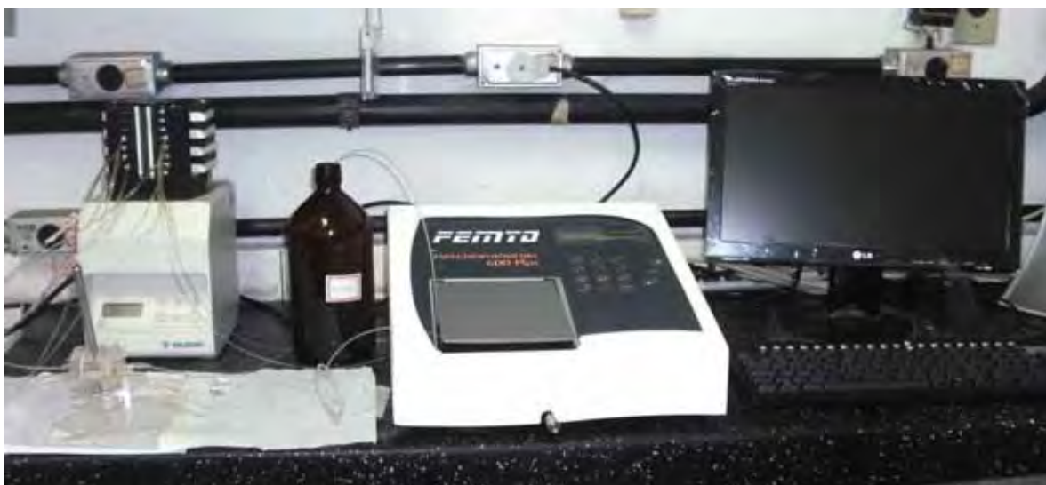
Figura 10- Foto do sistema FIA utilizado acoplado ao espectrofotômetro
