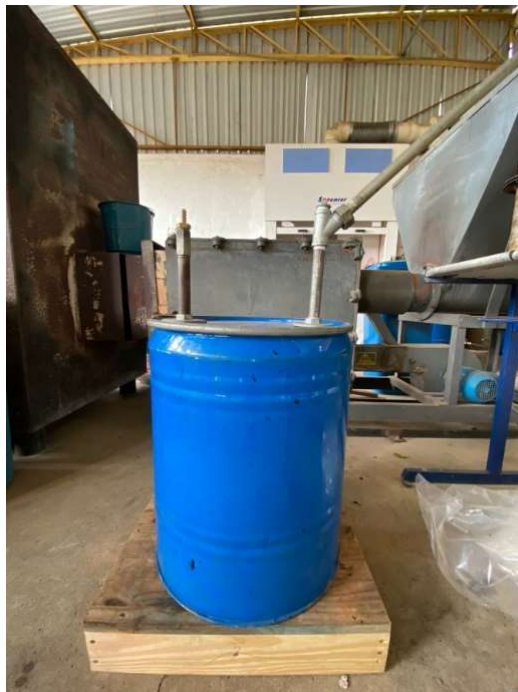
Figura 21 – Sistema de lavagem e anti-retrocesso de chama.
