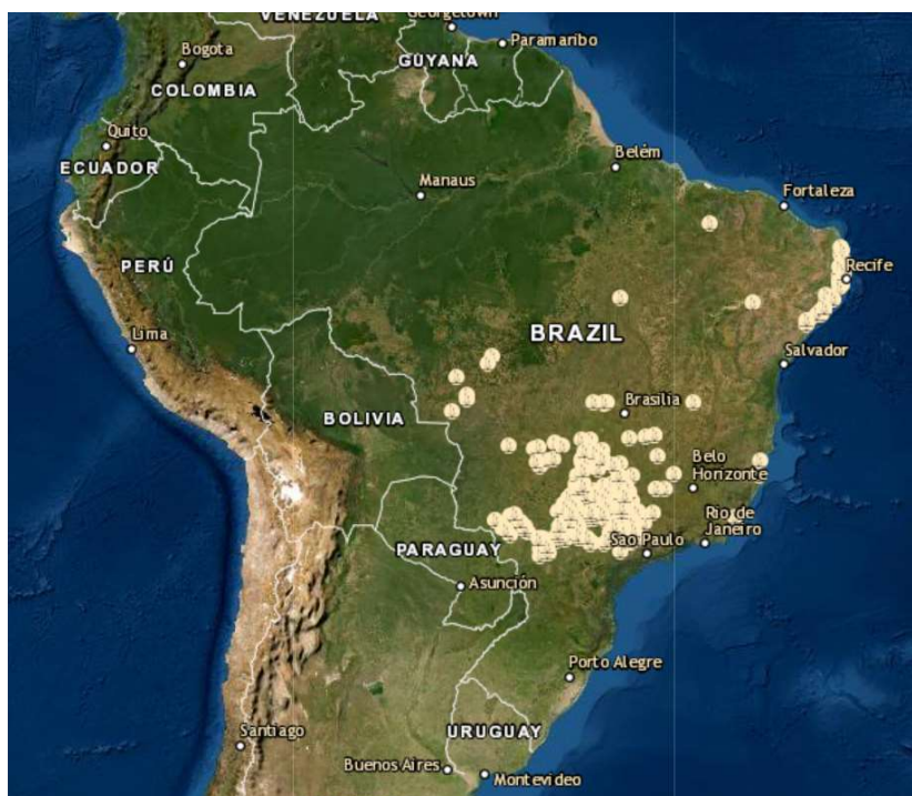
Figura 6 – Distribuição de usinas termelétricas a base de bagaço de cana-de-açúcar no Brasil.
