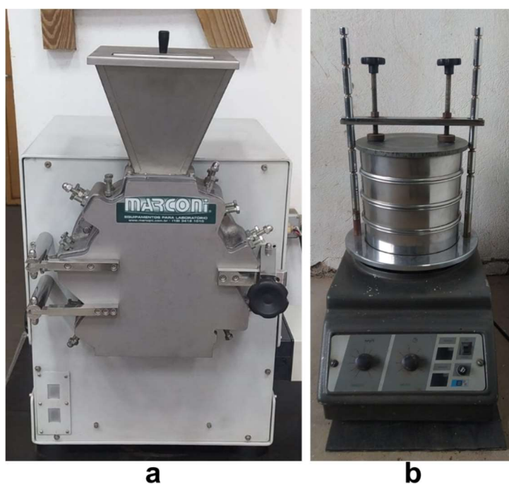
Figura 15 - Equipamentos para preparação do BCA (a) Moinho de facas - Marconi; (b) Agitador eletromagnético
