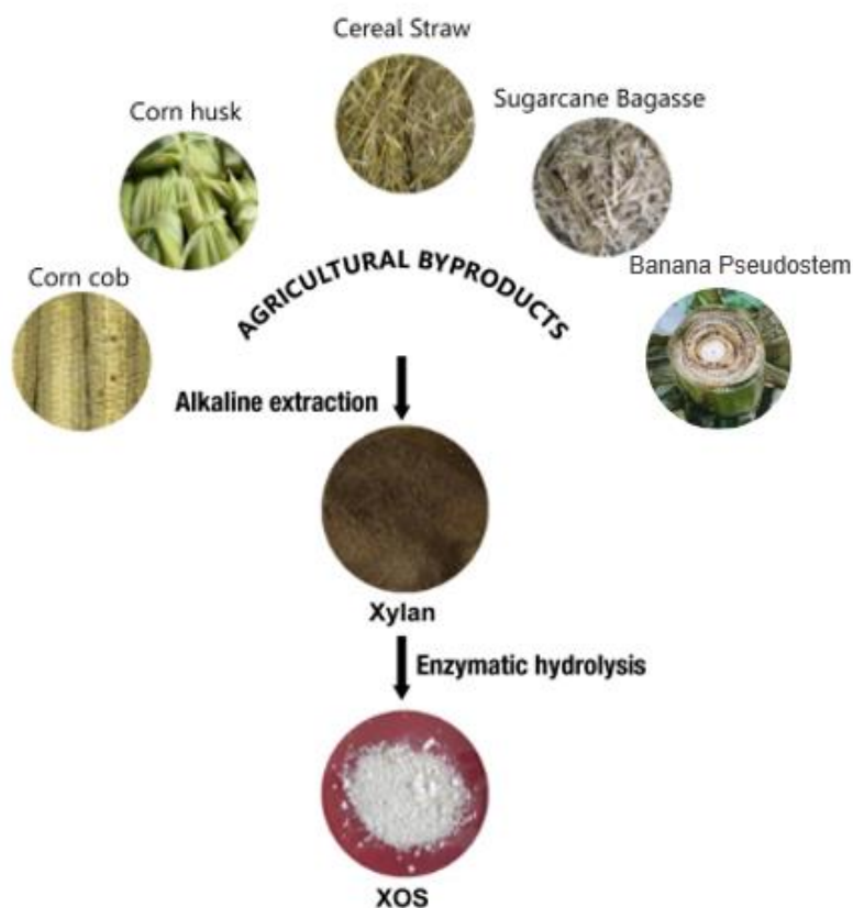
Figura 9. Representação esquemática da produção de xilo-oligossacarídeos a partir da hidrólise enzimática de materiais lignocelulósicos.
