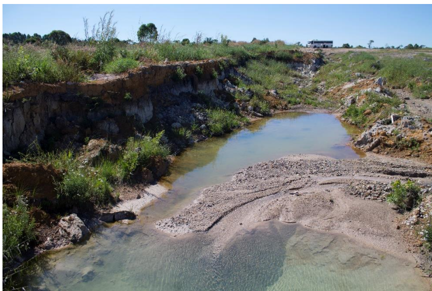
Figura 23 Exposição do nível freático em lavra de argila refratária
