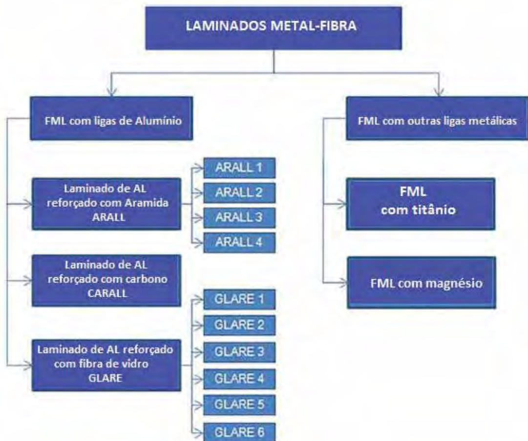
Figura 10 - Classificação dos FMLs baseados nas camadas de metal (adaptado SINMAZÇELIK, et al., 2011).
