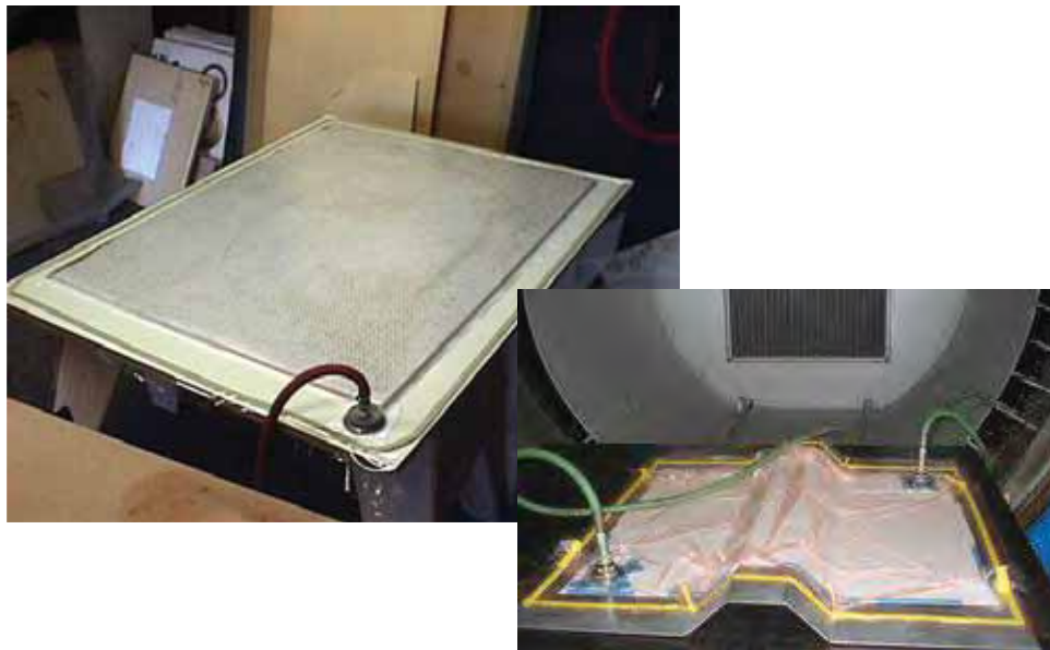
Figura 13 - Foto representativa de um sistema de saco de vácuo (adaptado DAMATO, 2010).
