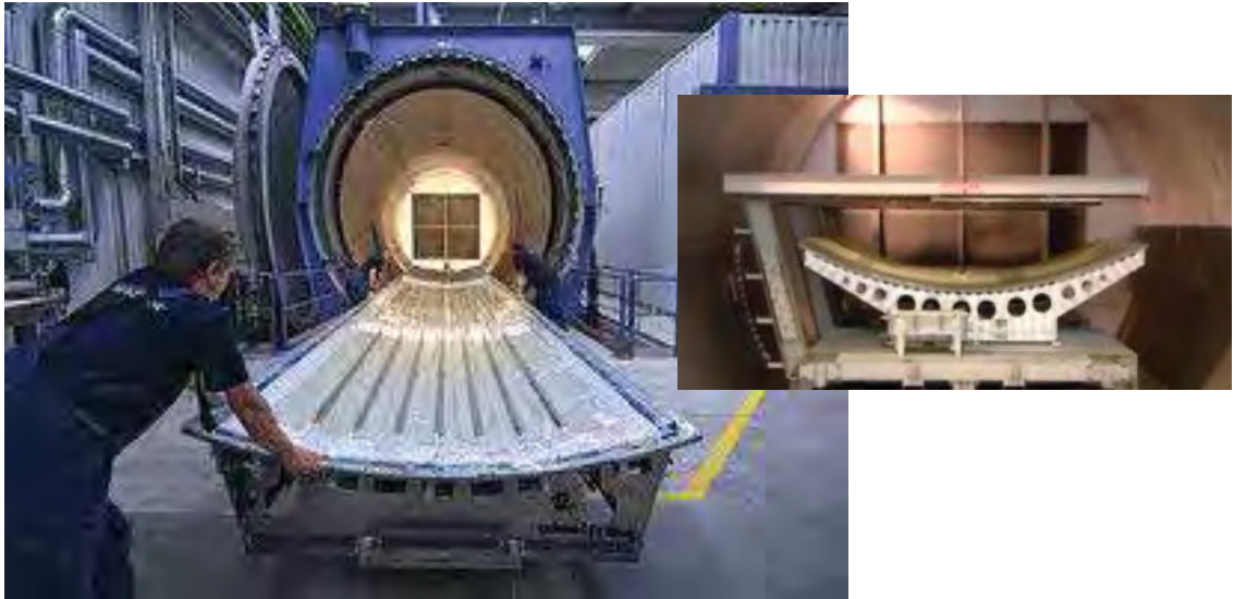
Figura 14 - Autoclave utilizada na obtenção dos laminados metal-fibra (adaptado DAMATO, 2010).
