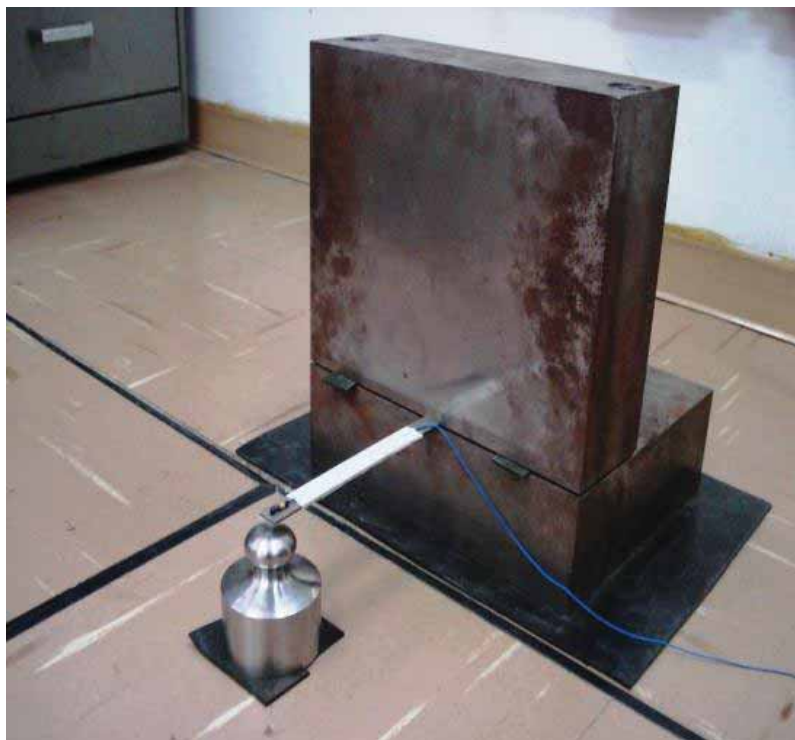
Figura 35 - Sistema utilizado na realização do ensaio de vibração livre.
