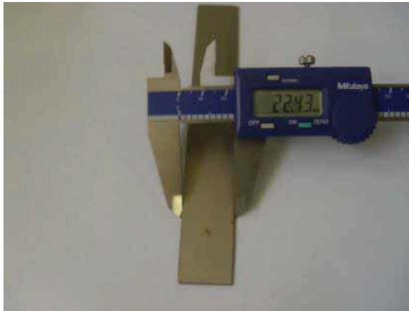
Figura 23 - Paquímetro utilizado para verificação da massa específica.
