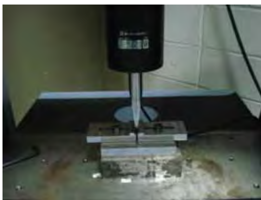
(a) (b) Figura 32 – (a – b): Ensaio de cisalhamento interlaminar - ILSS.
