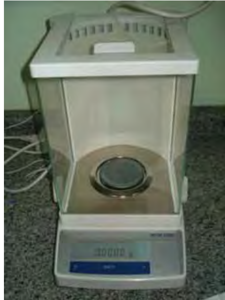
Figura 24 - Balança analítica utilizada para verificação da massa específica.
