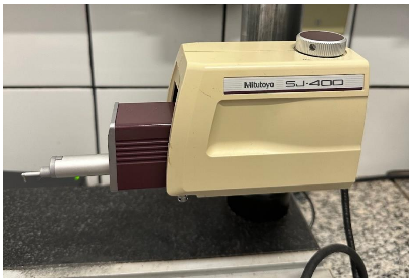
Figura 7 - Rugosímetro (MITUTOYO SJ-400).
