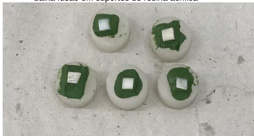
Figura 2 - Espécimes de esmalte recortados (5 x 5 mm) e fixados com godiva de baixa fusão em suportes de resina acrílica
