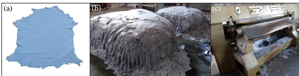
Figura 4. Couro após o tratamento com solução de sulfato básico de \text{Cr}^{3+} produzindo uma manta de couro que recebe o nome de wet-blue . Em (a) Manta de couro wet-blue esticada; (b) Pilha de couro wet-blue no curtume e em (c) Rebaixadeira e serragem (pó de rebaixadeira) resultante da operação de rebaixamento.
