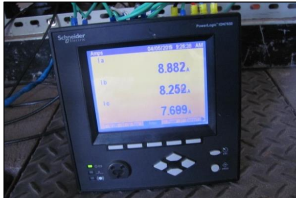
Figura 32 – Foto do medidor ION7650 utilizado para as medições de harmônicos
