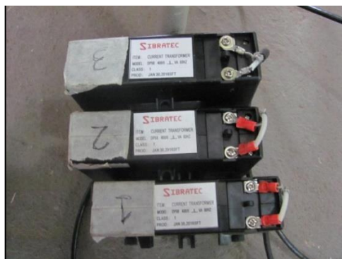
Figura 58 – Foto dos transformadores de corrente utilizados nas medições
