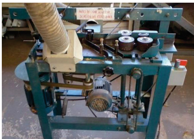
Figura 16. Fresadora duas faces, desenvolvida especialmente para a confecção de ripas laminadas de bambu.
