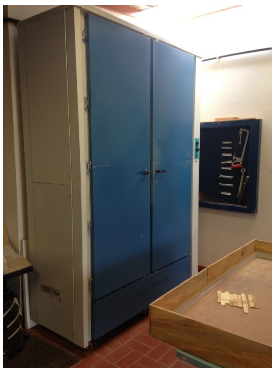
Figura 22. Estufa com renovação e circulação de ar Marconi
