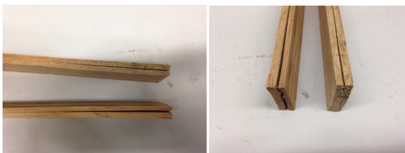
Figura 46. Padrão de ruptura ocorrido nas ripas expostas à temperaturas superiores a 160° C, após teste de flexão estática
