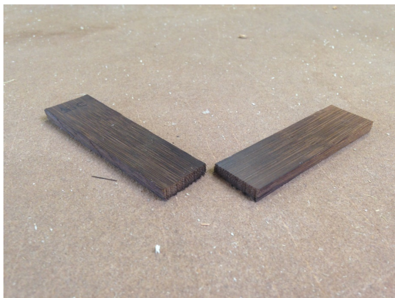
Figura 49. Aspecto das camadas internas de uma ripa termo-tratada fracionada após tratamento térmico
