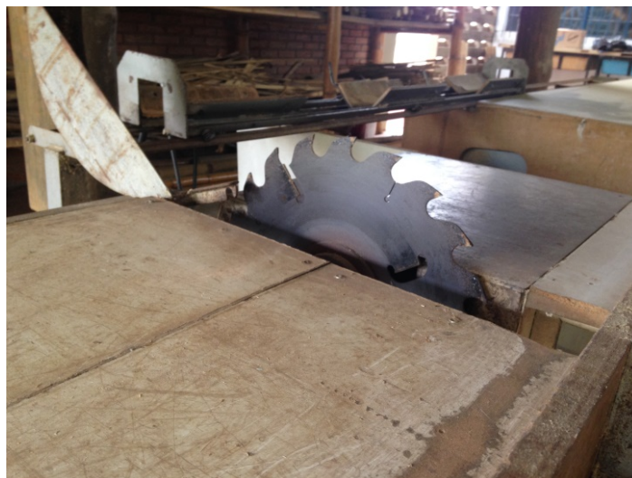
Figura 13. Serra circular destopadeira com mesa deslizante para o fracionamento transversal dos colmos
