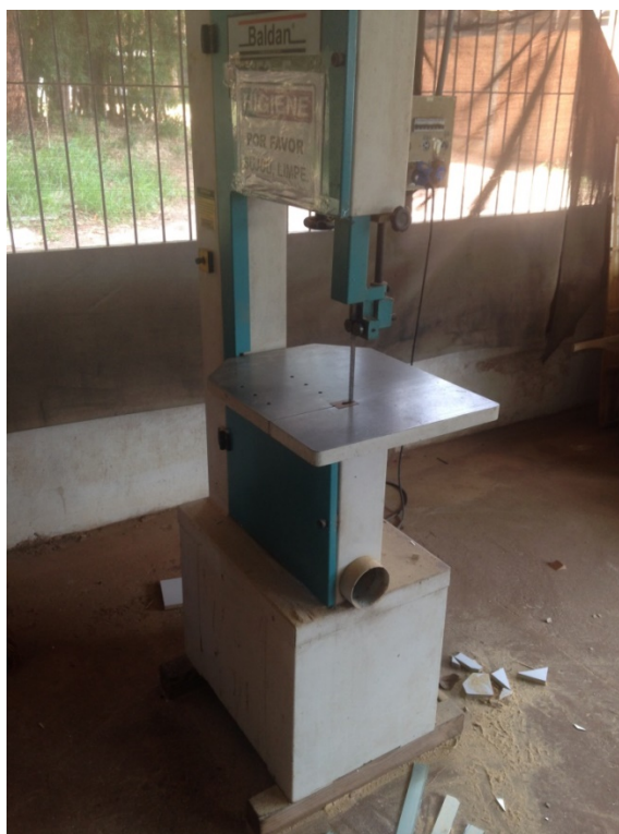
Figura 21. Serra de fita vertical para madeira da marca Baldan
