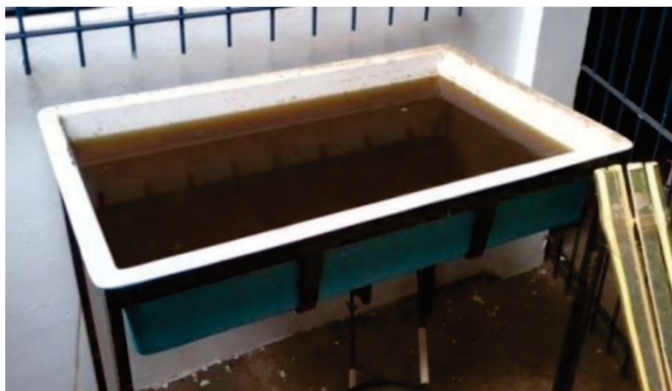
Figura 17. Tanque para tratamento preservativo do bambu por imersão
