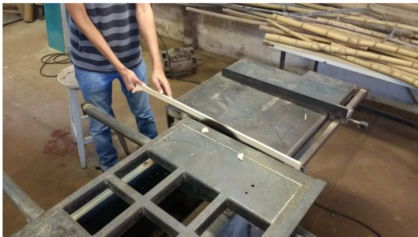
Figura 35. Beneficiamento em serra circular esquadrejadeira
