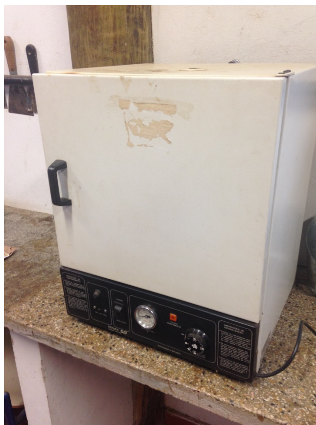
Figura 24. Estufa da Ad, modelo 480 ES com controle de temperatura de até 300°C
