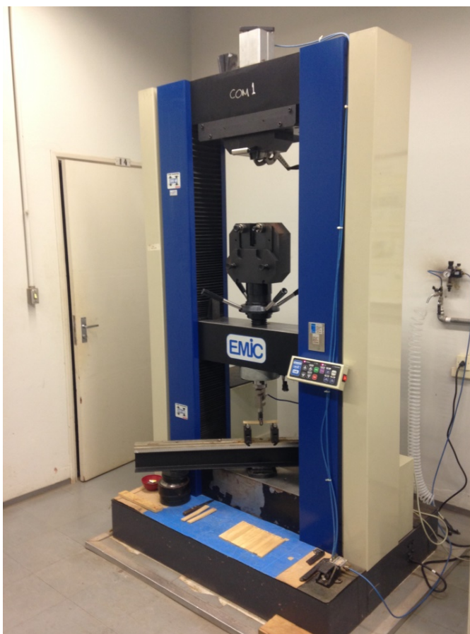
Figura 25. Máquina Universal de Ensaio EMIC, modelo DL 30.000
