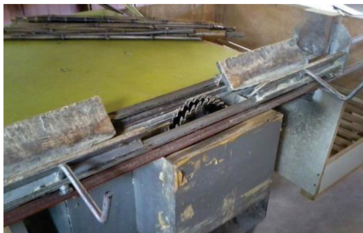
Figura 14. Serra circular refiladeira dupla, com suporte deslizante para o bambu para o fracionamento longitudinal dos colmos para obtenção de ripas
