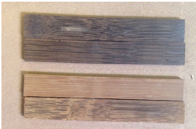
Figura 48. O escurecimento da ripa não altera as suas características superficiais originais
