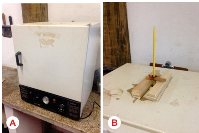
Figura 41. Tratamento térmico em estufa (A) com auxílio de termômetro (B) para controle da temperatura
