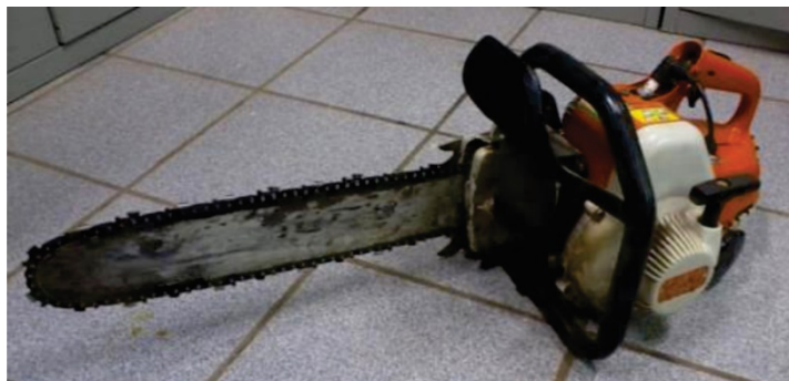
Figura 12. Motosserra movida à gasolina com sabre de 14 polegadas para a colheita dos colmos
