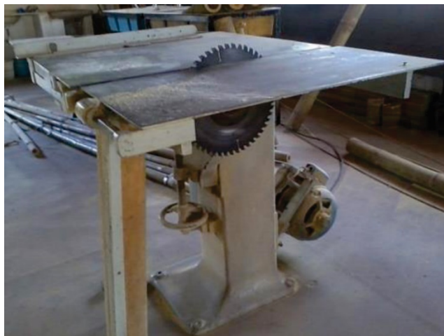
Figura 15. Serra circular esquadrejadeira para a uniformização das ripas
