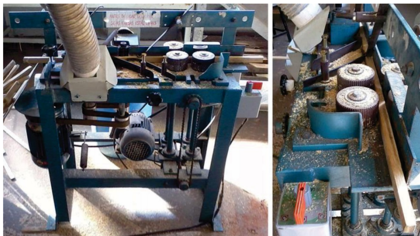
Figura 36. Etapa de fresamento de ripas em fresadora duas faces
