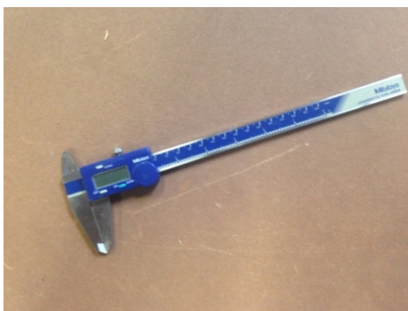
Figura 19. Paquímetro digital Mitutoyo com resolução de 0,01 mm
