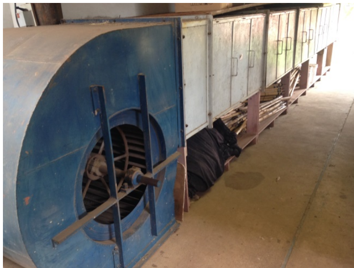
Figura 27. Túnel de vento para secagem do bambu por ventilação forçada
