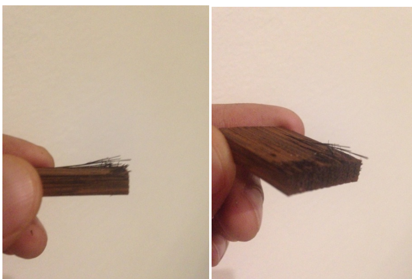
Figura 47. Tendência de “descolamento” das fibras observado após corte das ripas submetidas à temperatura de 200° C
