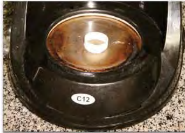
Figura 32. Secagem de anel de metal clay com o uso de base elétrica.
