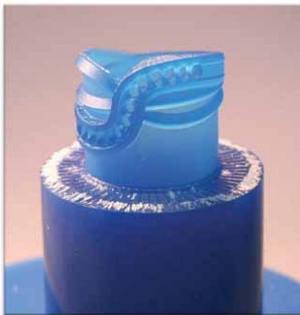
Figura 44: Anel de cera esculpido por fresa eletrônica.
