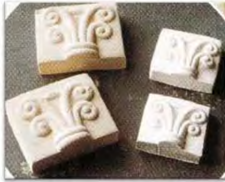
Figura 38: Encolhimento de Peças de MC (Fonte: CODINA, 2005).
