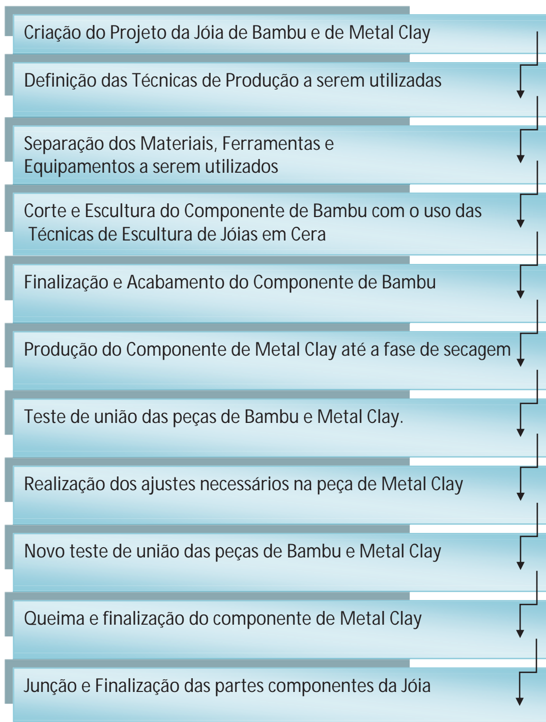
Figura 103. Processo de Produção de Jóias Ecológicas de Bambu e MC
