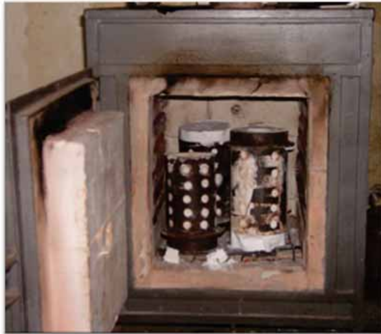
Figura 51: Fundição por cera perdida – Forno.
