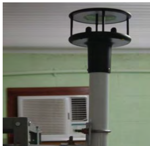
Figura A.52 – Anemômetro Windsonic Direcionado a ventos forçados
