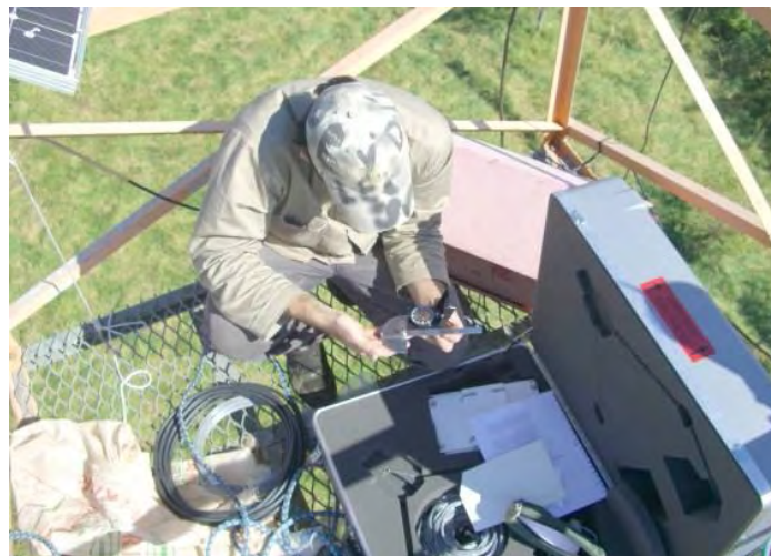
Figura A.36 – Bússola e goniômetro em mãos e Placa de PVC para direcionamento do ângulo de 158^{\circ}20' sobre a caixa do Anemômetro 3D
