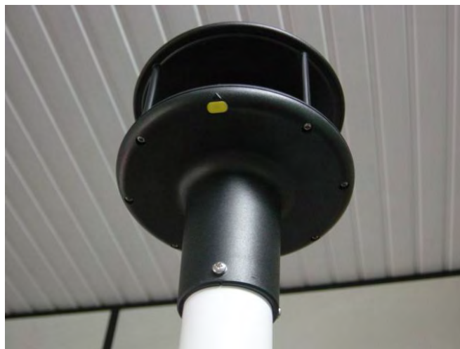
Figura A.55 – Detalhe marcação (apontamento para norte) do Anemômetro Windsonic
