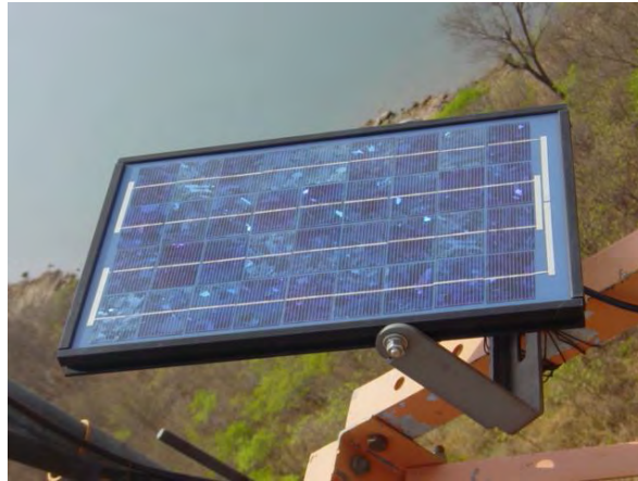
Figura A.57 – Painel Solar utilizado no Anemômetro Windsonic
