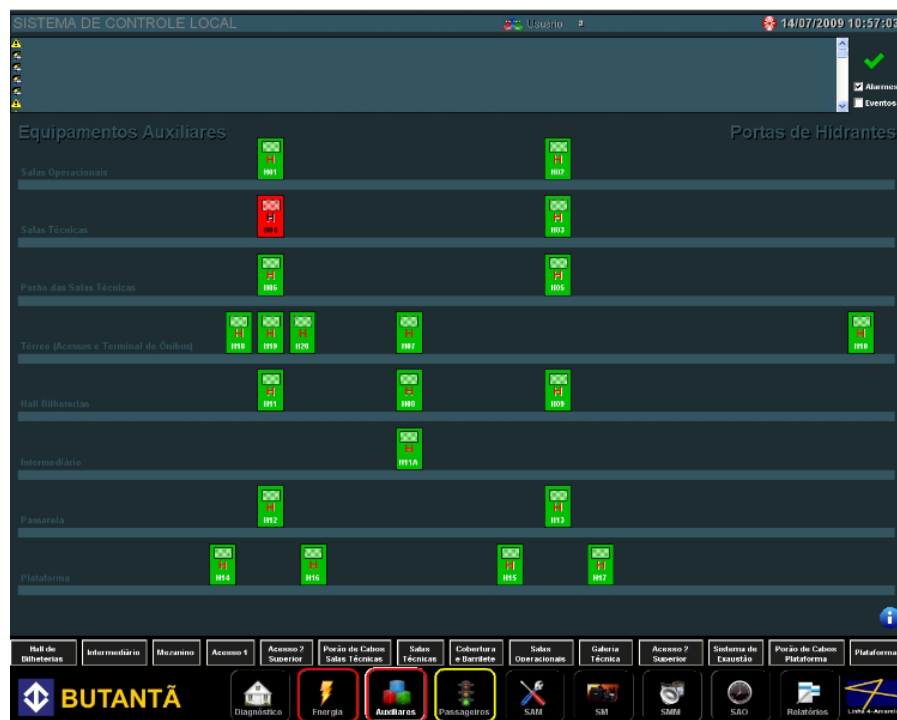
Figura 31 – Supervisório Local da estação Butantã exibindo a tela com os hidrantes monitorados pelo SCADA.
