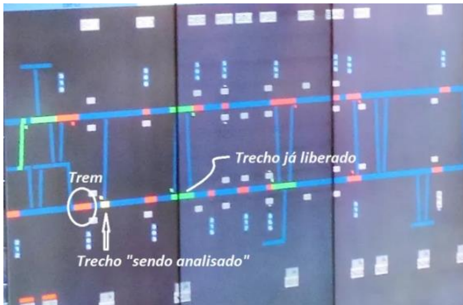
Figura 27 – Painel sinótico do CCO exibindo SCADA do sistema de sinalização de trens.
