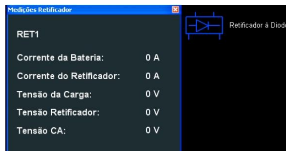
Figura 23 – Tela exibindo as medições analógicas de um retificador à diodo.
