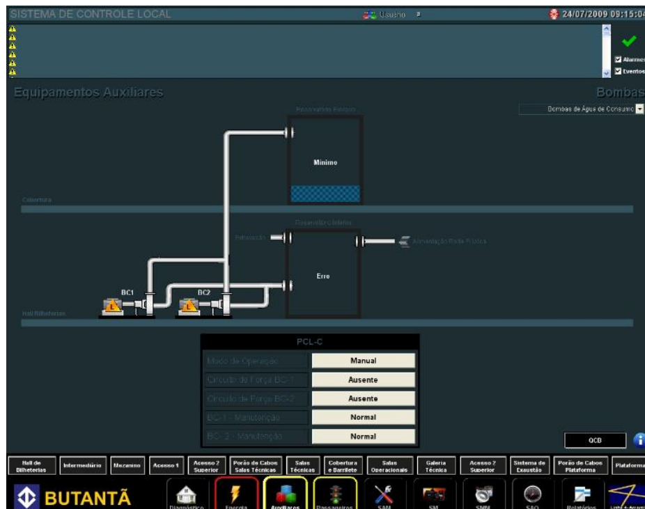
Figura 32 - Supervisório Local da estação Butantã exibindo a tela com as bombas d'água monitorados pelo SCADA.
