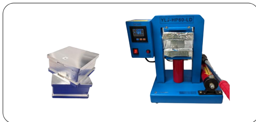
Figura 10 - Molde de alumínio e máquina de prensagem à quente para produção dos biocompósitos.
