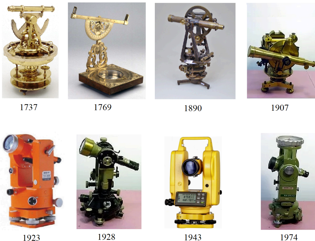
Figura 26 - Evolução do teodolito.
