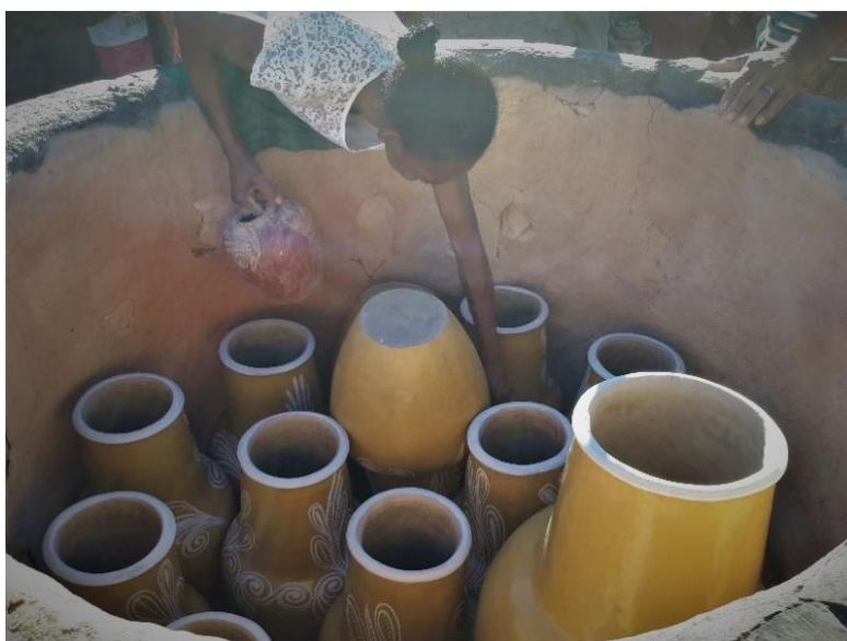
Figura 79. Laurenice monta sua fornada: potes grandes ocupam a parte inferior do forno. Associação de Cerâmica, Barra, Bahia, 2017. Fonte: fotografia da autora.
