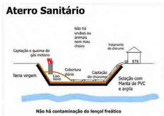
Figura 4 – Representação de um Aterro Sanitário (www.lixo.com.br em 02/09/2011)
