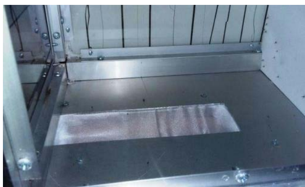
Figura 12. Gaiola dividida pela metade para impedir a fuga e a mortalidade dos insetos.
