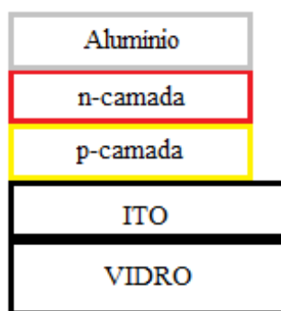
Figura 4: Estrutura de uma célula solar de junção p-n .
