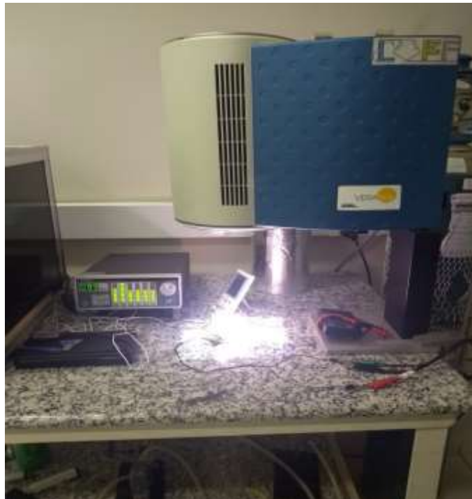
Figura 17: Simulador solar Oriel Vera Sol (AM 1,5G).
