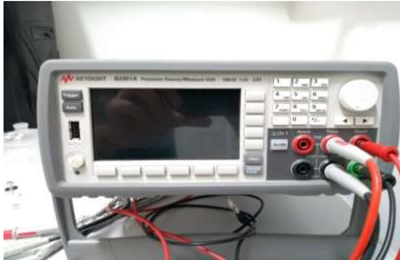
Figura 16: Fonte de tensão Keysight modelo B2901A.
