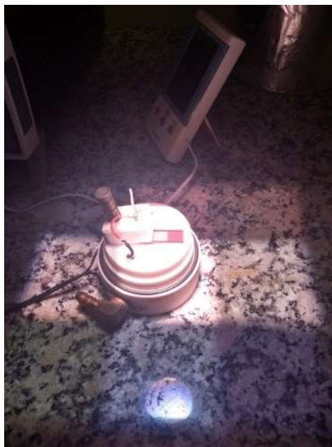
Figura 31: Suporte de amostra e filme sendo irradiado.
