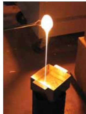
Figura 19 – (a) Forno elétrico programável com mesa elevatória; (b) Cadinho com matéria prima apoiado sobre outro cadinho contendo alumina eletrofundida (c) Molde de grafite (d) Vazamento do vidro fundido no molde de grafite (e) Recipiente em aço inox com água a temperatura ambiente e (f) Vazamento do vidro fundido no recipiente de inox contendo água.
