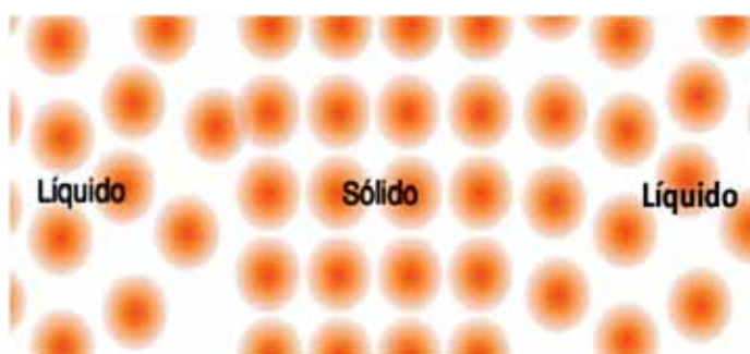
Figura 10 – Mostra da interface líquido/sólido no processo de crescimento de cristais. Fonte: Cardoso (2005).
