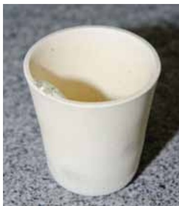
Figura 18 – Cadinho com 78% de mulita[ 3(\text{Al}_2\text{O}_3).2(\text{SiO}_2) ] e 22% de zircônia[ (\text{ZrO}_2) ]
