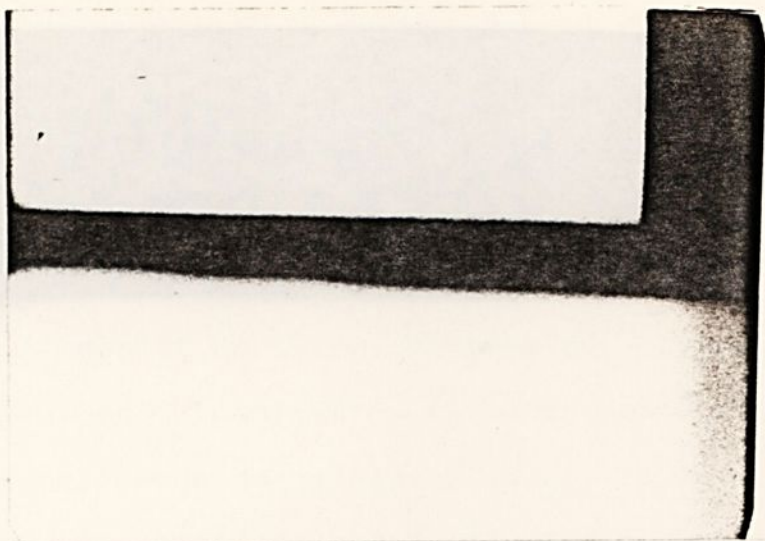
fig. 33 - Penetrômetros de ferro e cobre a 200 kV e 5 mA por dois minutos ; o contraste só foi detectado no degrau de 1 mm do penetrômetro de ferro.
