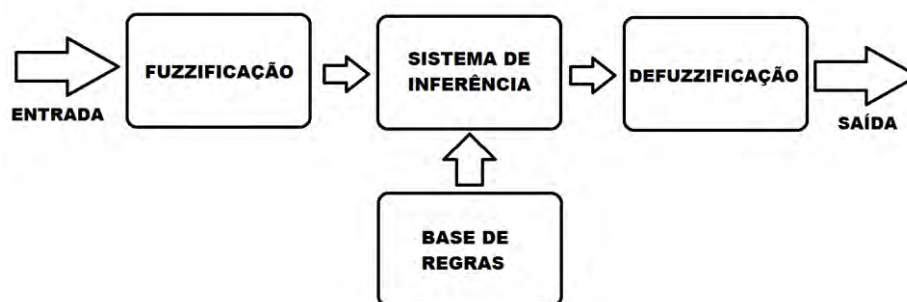
Figura 37 – Diagrama esquemático de um sistema fuzzy
