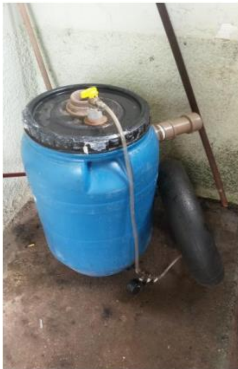
Figura 3. Biodigestor montado com câmara de gás instalada (a), sensor para medição da concentração de gás metano (b).
