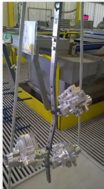
Figura 11 - Gancheiras com produtos montados, 8 peças (a) e 3 peças (b)
