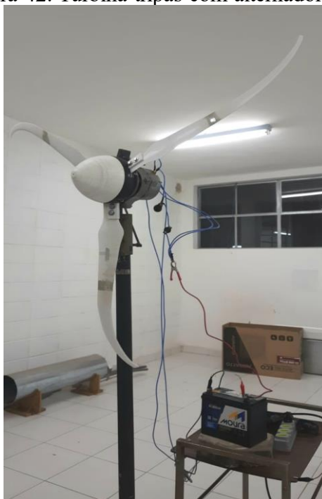
Figura 42. Turbina tripás com alternador Delco-Arno
