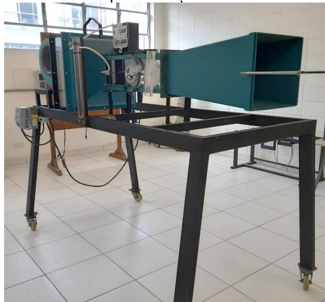
Figura 33. Túnel de vento para obtenção da velocidade linear do vento
