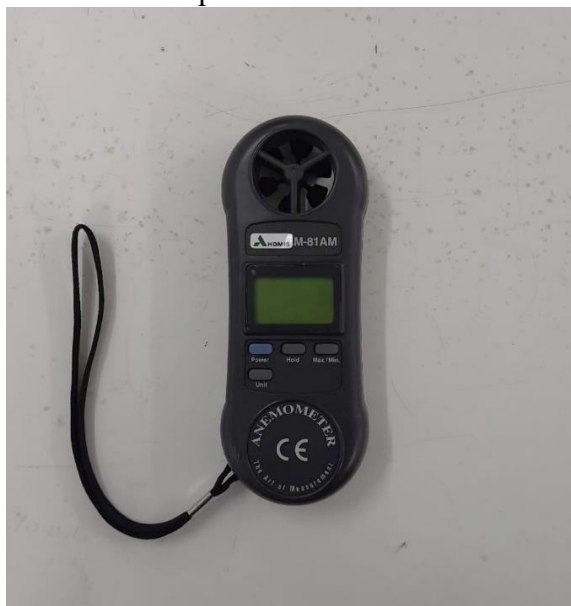
Figura 34. Anemômetro para velocidade linear do vento em m/s
