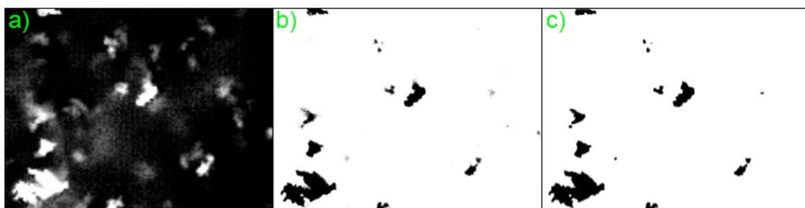
Figura 18: Imagem do momento 0 minutos de sedimentação a) versão original, b) limiarizada e c) binarizada.
