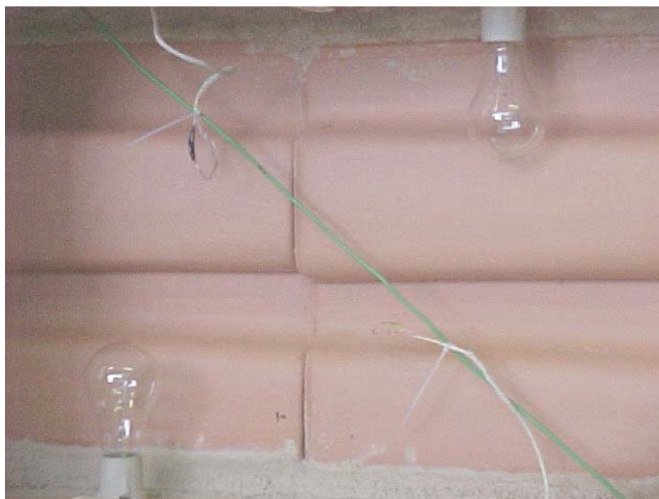
Figura 25. Instalação dos termopares t_1 e t_2 .
