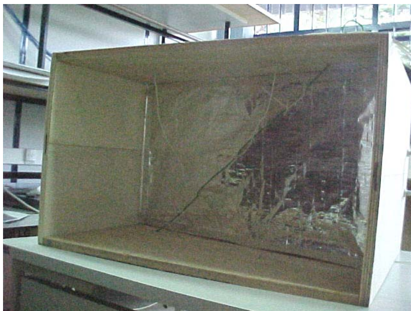
Figura 23. Vista da parte inferior do modelo, destacando-se a instalação da subcobertura.
