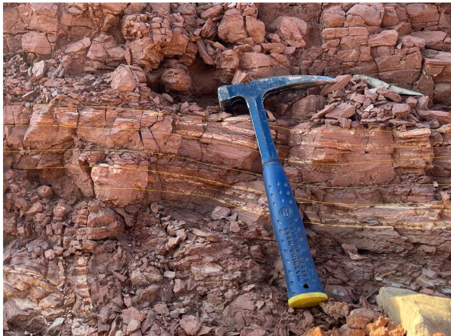
Figura 6: Siltito laminado de coloração marrom avermelhado dentro do Grupo Itararé.
