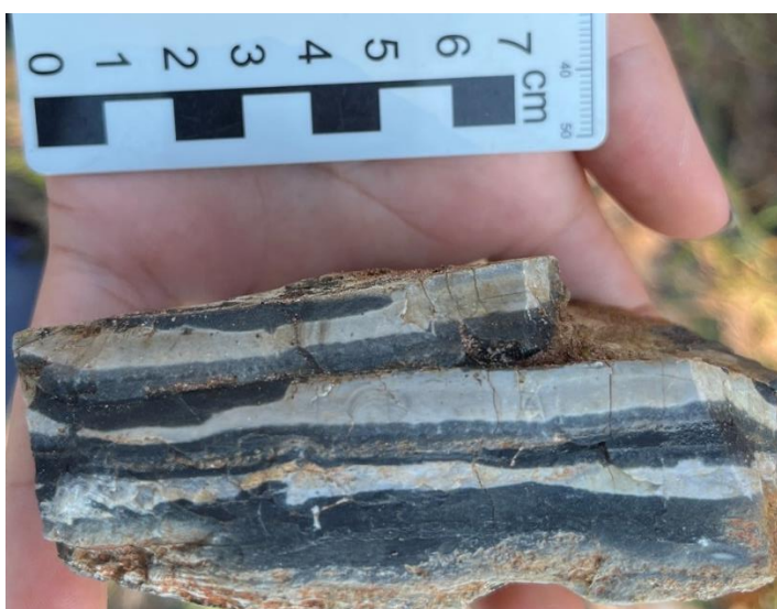
Figura 12: Folhelho silicificado da Formação Irati. Afloramento encontrado estava muito alterado, com alguns blocos soltos do material que continha mais sílica.
