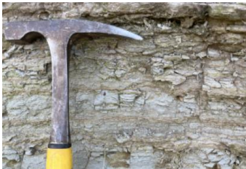
Figura 9: Siltito arenoso com laminação plano paralela, coloração branca a amarelo.
