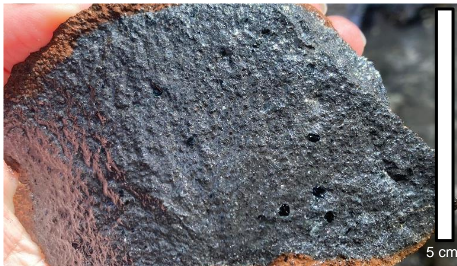
Figura 19: Diabásio de coloração preta, aflorando como bloco rolado em drenagem, alterando para colorações avermelhadas, correlato à Formação Serra Geral.
