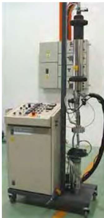
Figura 4.4 – Exemplo de Infusora utilizada para a fabricação das placas em VARTM
