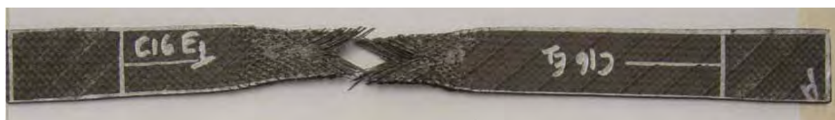
Figura 5.21 – Modo de falha típico apresentado durante os ensaios de cisalhamento planar.
