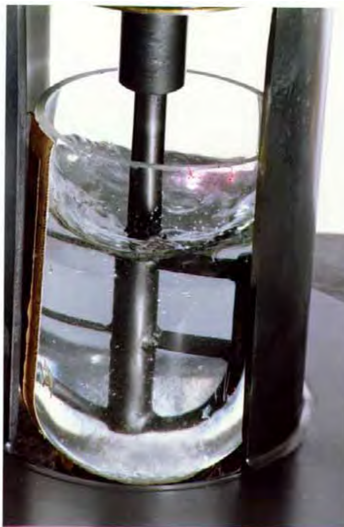
Figura 25. Modelo de fluxo obtido usando a âncora modificada, com rotação 160 rpm, em tanque com toro esférico.
