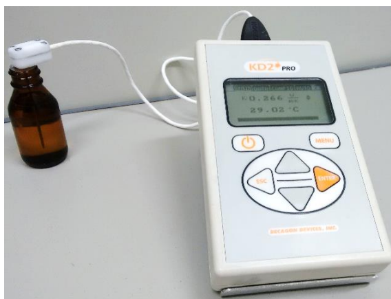
Figura 14. Analisador de propriedades térmicas KD2 Pró Decagon.
