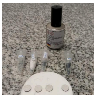
Figura 11- Amostras com eletrodo de prata depositado
