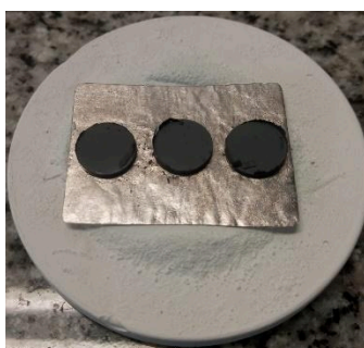
Figura 8- Amostras prensadas na forma de pastilhas da mistura de \text{CuO}/\text{TiO}_2
