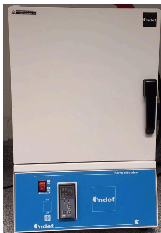
Figura 6- Forno Indef 273 P.20 utilizado para a calcinação e sinterização das amostras.
