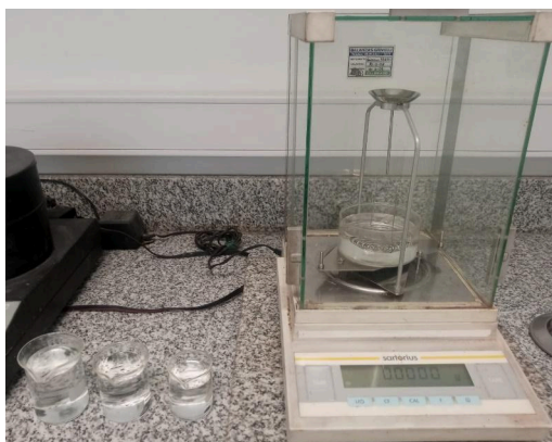
Figura 10- Balança analítica com suporte para utilizar o Método de Arquimedes
