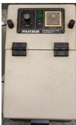
Figura 7- Moinho FRITSCH planetary micro mil pulverisette 7 utilizado para mistura e eliminação de pescoços das amostras.
