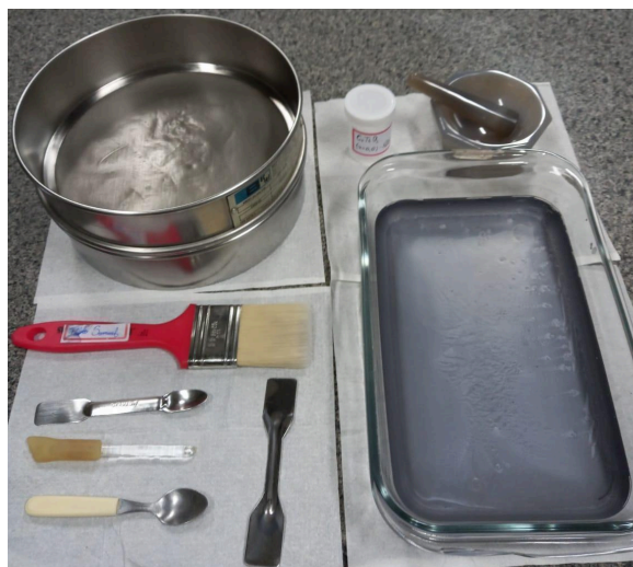
Figura 4- Peneira de malha 200 mesh e almofariz ágata do laboratório de materiais cerâmicos FEG-UNESP
