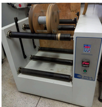
Figura 3- Moinho rotativo utilizado na mistura e homogeneização dos pós.
