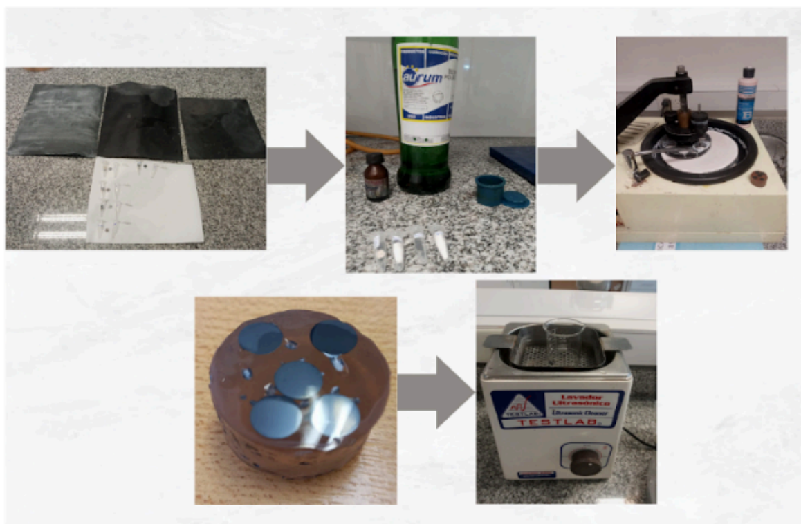
Figura 12- Etapas do processo de ceramografia das amostras: lixamento, polimento e banho ultrassônico
