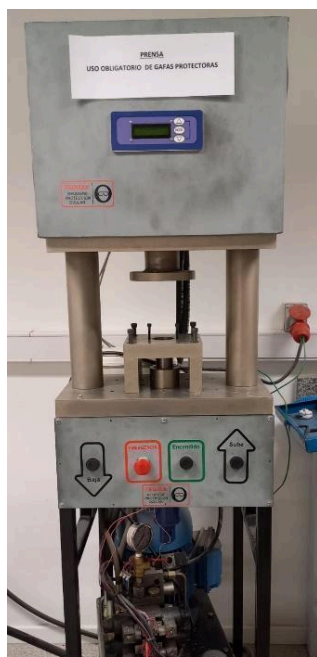
Figura 9- Prensa automática utilizada para conformação de corpos cerâmicos à verdes
