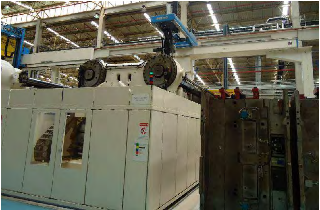
Figura 24. Máquina injetora Husky de 2700t (MOURA, 2011)
