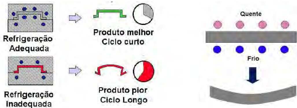
Figura 16. Exemplos de distribuição de canais de refrigeração ao redor da cavidade e seu efeito na formação da peça injetada. (SANTANA, 2008)
