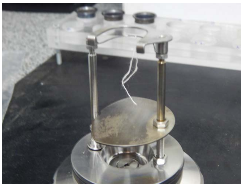
Figura 17 - Fio de algodão amarrado no eletrodo
