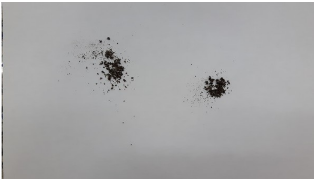
Figura 19 - Cinzas após a combustão do lodo
