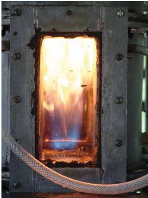
Figura 22 – Chama gerada pela queima de GLP com ar
