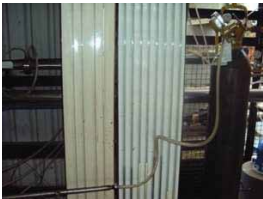
Figura 27 – Cilindro de oxigênio e placa de orifício conectados ao manômetro em U
