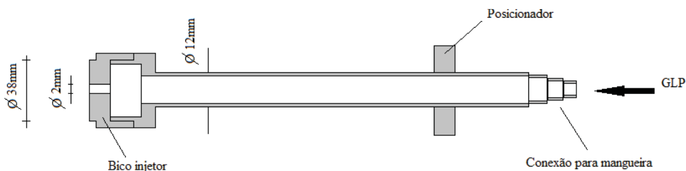
Figura 23 – Esquema do queimador de GLP
