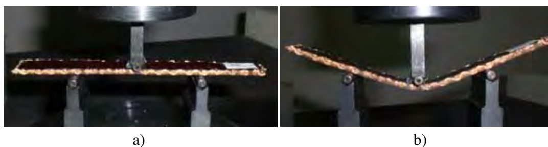
Figura 5.35 – Ensaio de flexão em 3 pontos no laminado fenólica/sisal úmido: a) início do ensaio e b) após 6 min de ensaio
