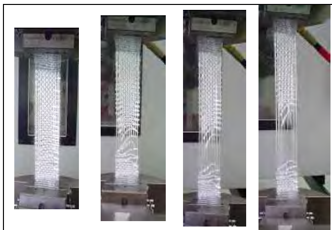
Figura 5.22 – Comportamento do tecido com fibras de vidro no ensaio de tração
