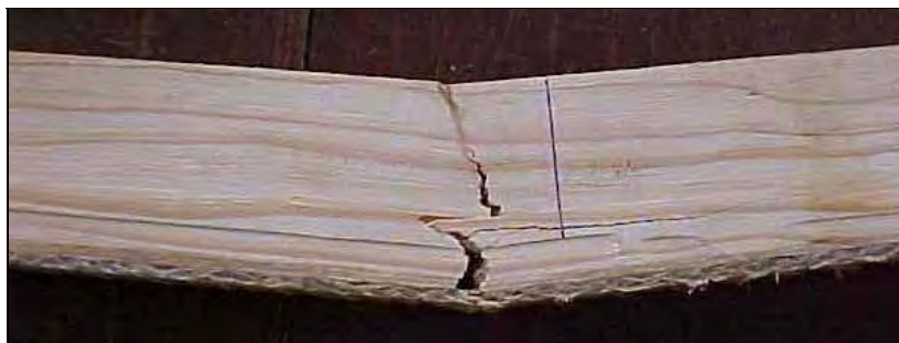
Figura 1.1 – Ruptura por flexão do corpo-de-prova reforçado na parte inferior pelo laminado epóxi/sisal (CARVALHO, 2005)
