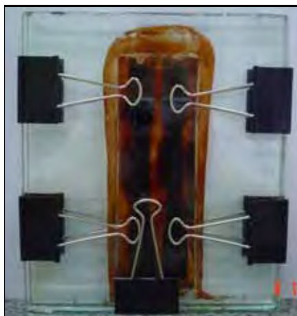
Figura 4.3 – Molde para confecção dos corpos-de-prova para ensaio de tração na resina
