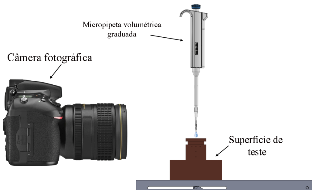
Figura 10 - Esquema do aparato experimental utilizado para medição do ângulo de contato
