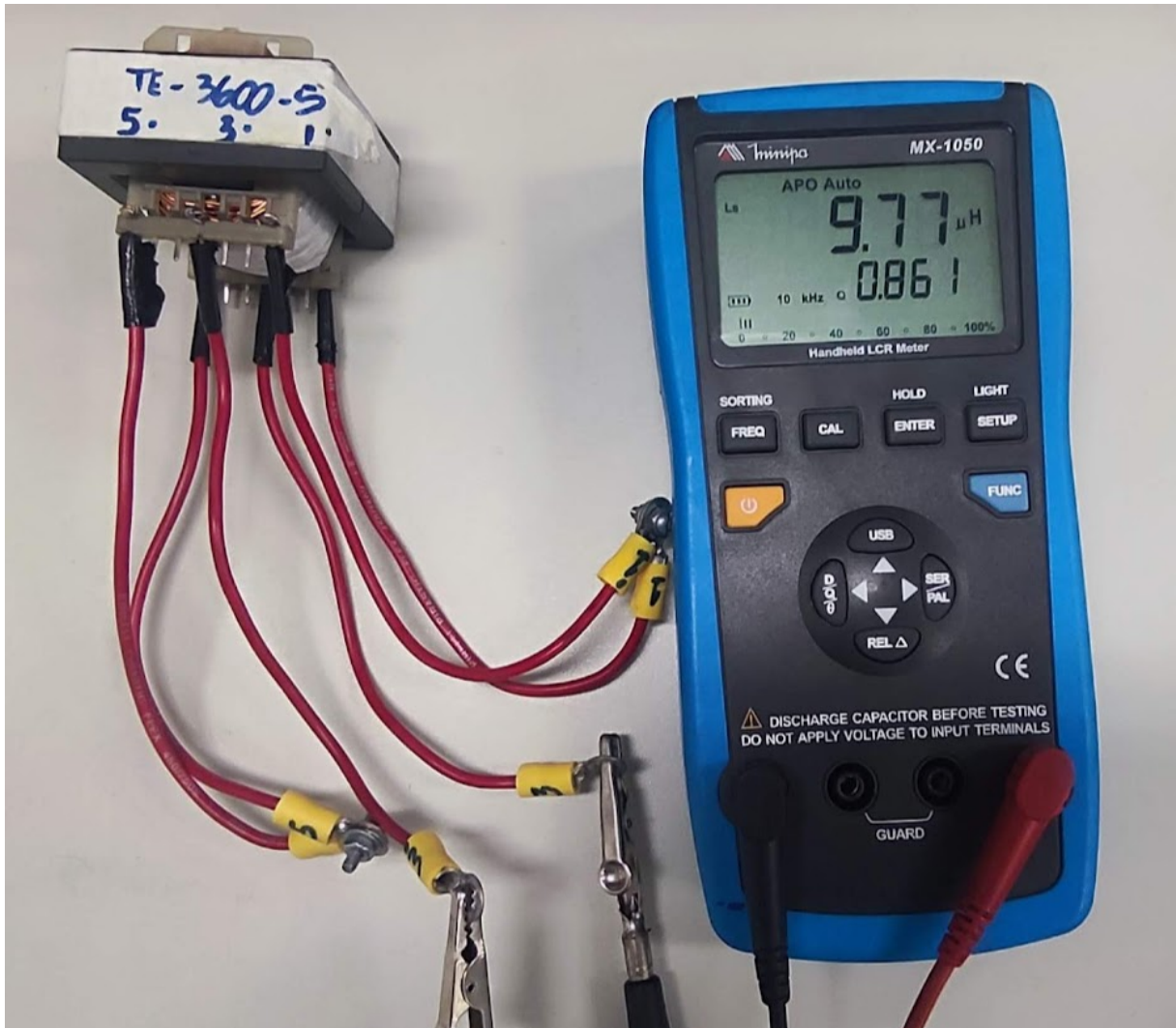
Figura 58 – Medição da indutância de dispersão equivalente L_{K3eq} .
