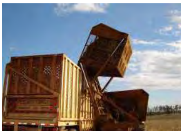
Figura 18. Transbordo descarregando cana picada numa carreta para transporte.
