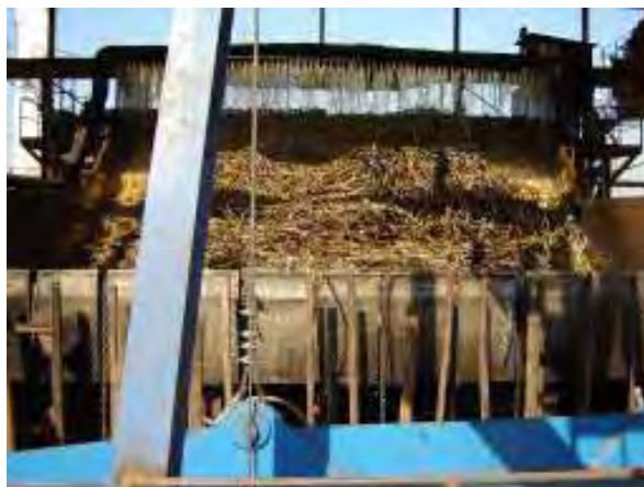
Figura 45. Cana sendo espalhada por esteiras na mesa alimentadora.
