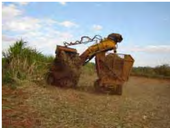
Figura 17. Colheitadeira em operação utilizando-se do transbordo para depositar a cana picada.
