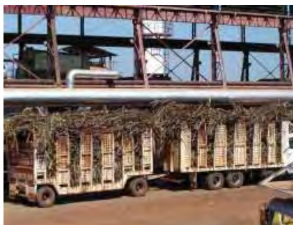
Figura 41. Comboio com cana colhida manualmente, pronta para descarga.
