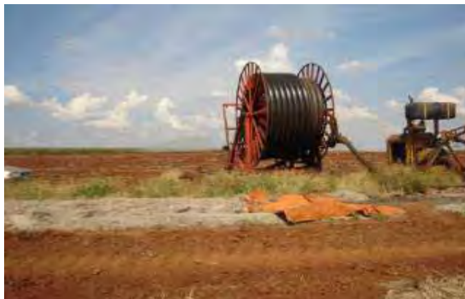
Figura 5. Mangueiras para sucção da vinhaça para irrigação.
