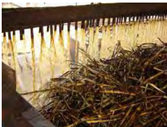
Figura 46. Cana sendo lavada no interior da mesa alimentadora.
