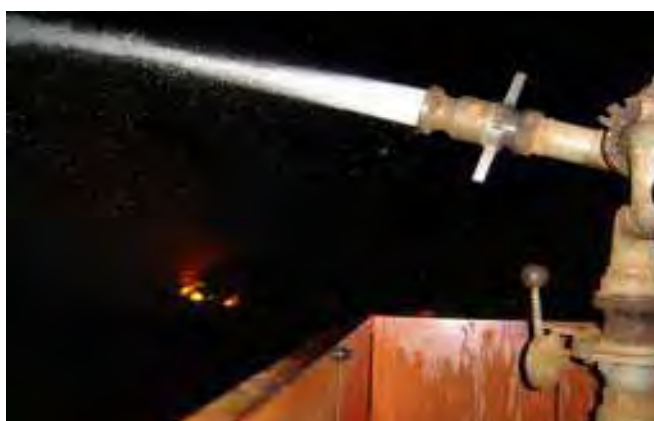
Figura 12. Jatos de água do caminhão tanque para molhar e preservar áreas vizinhas.
