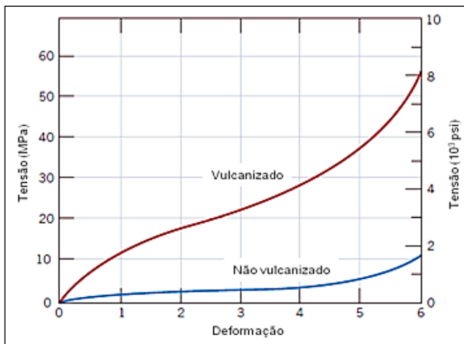
Figura 6 – Curva de tensão x deformação para BN vulcanizado e não vulcanizado a um alongamento de 600%.
