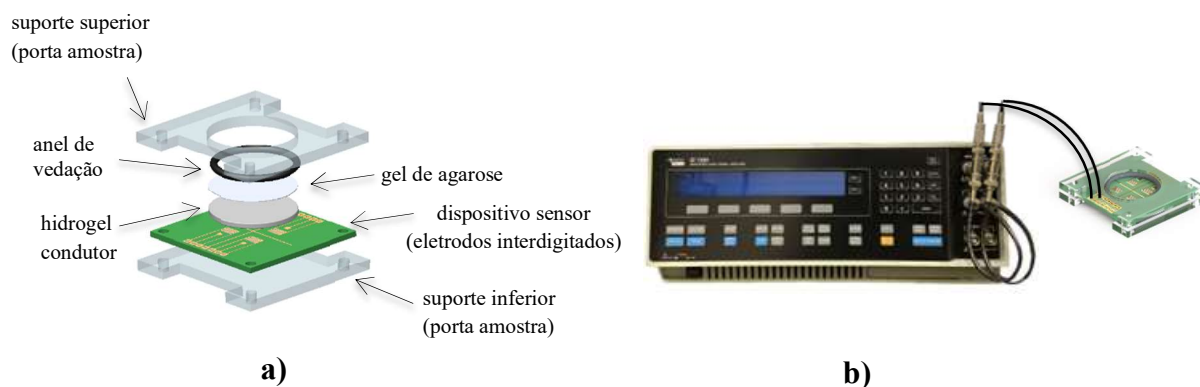
Figura 22: Vista tridimensional do sistema matricial de detecção de íons de metais pesados completo a) e sistema de medida elétrica por espectroscopia de impedância inserindo solução iônica no pocinho do porta amostra b) . Elaborado pelo autor.
