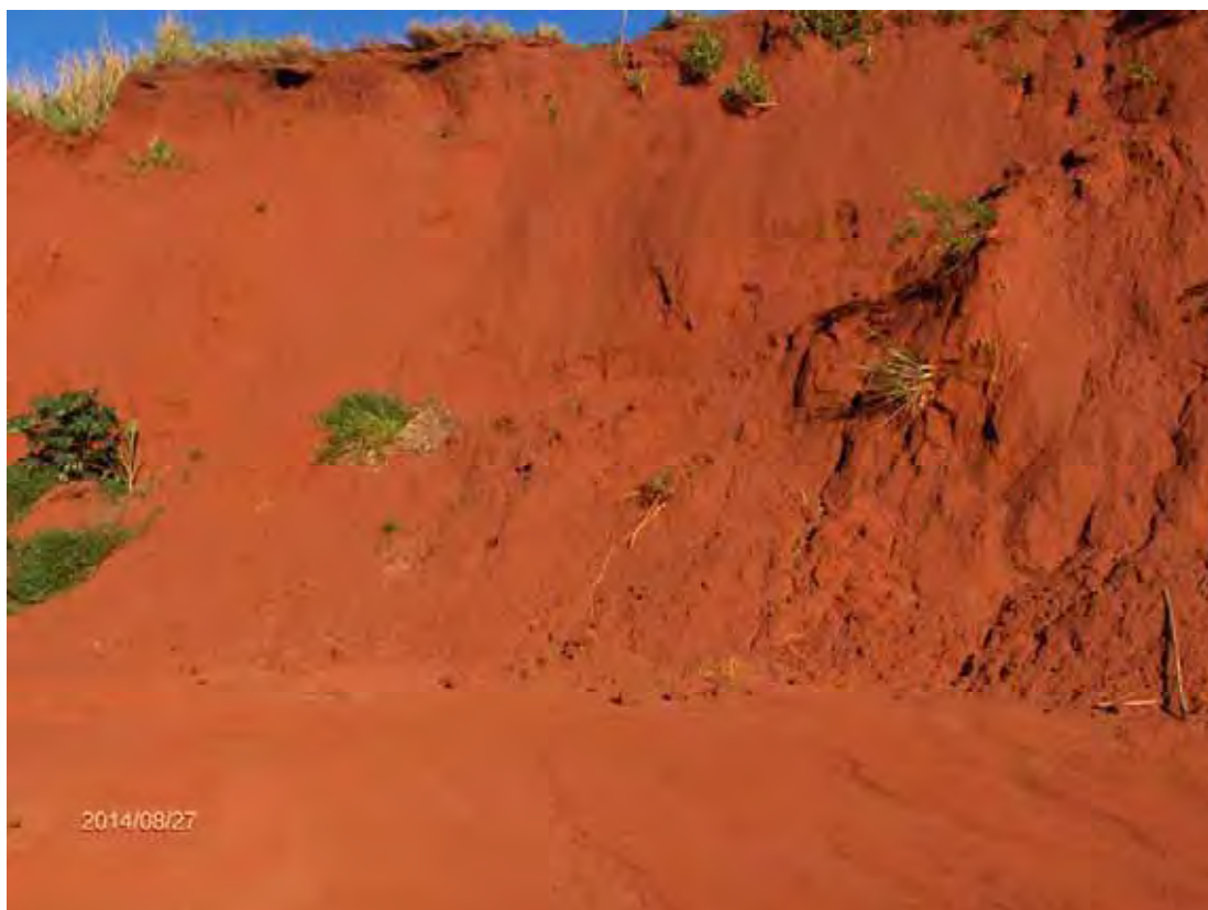
Figura 38 - Aloformação Paranaíba, unidade 1. Material inconsolidado constituído por grãos de quartzo e películas de óxidos e hidróxidos de ferro, coloração vermelho intenso a alaranjado, SP-333 – Rodovia Miguel Jubran, divisa de município Assis – Tarumã (Ponto 9).
