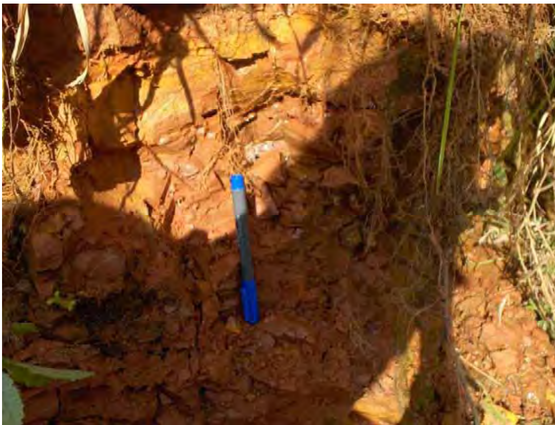
Figura 21 - Água do Fortuninha – arenito vermelho com matriz siltico-argilosa, Formação Adamantina (Ponto 8).
