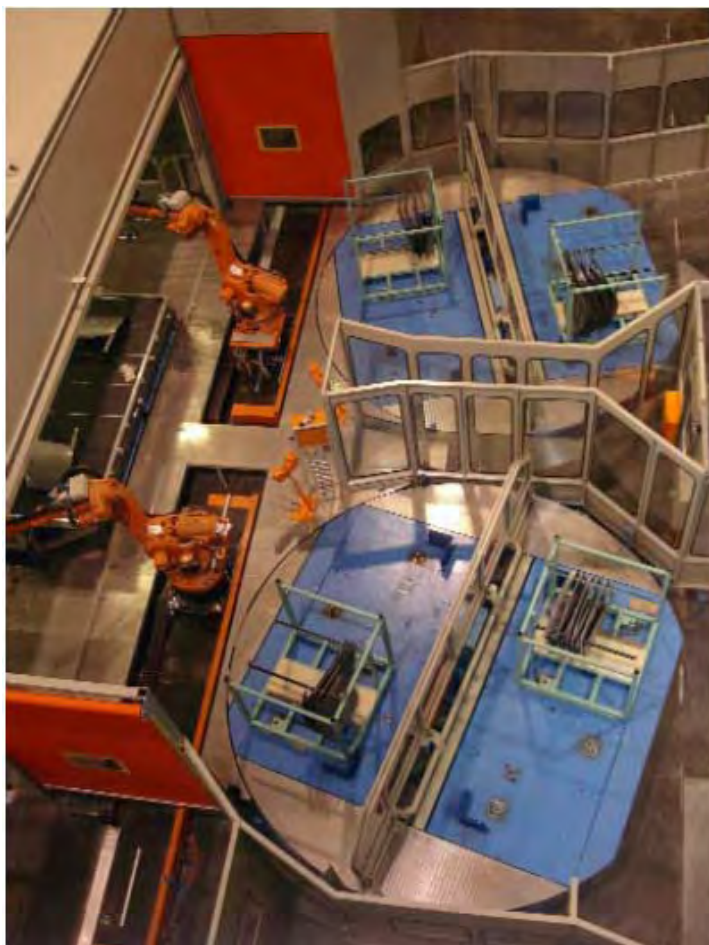
Figura 20. Célula, ABB, possui entradas a esquerda e saídas à direita 28 .
