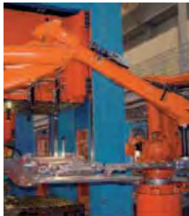
Figura 27. Substituição do homem pelo robô junto a prensa.
