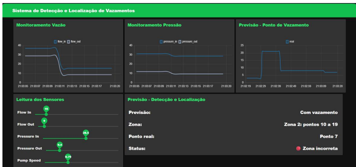
Figura 19 – Dashboard do sistema de detecção e localização de vazamentos
